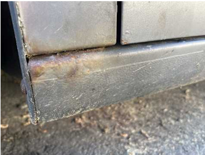
Schweller links (Rost)
