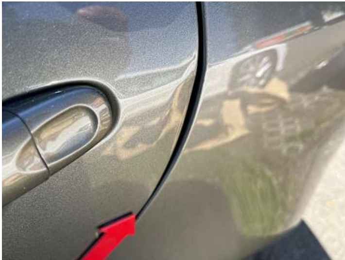
Türe hinten links (Delle, Verformung)
