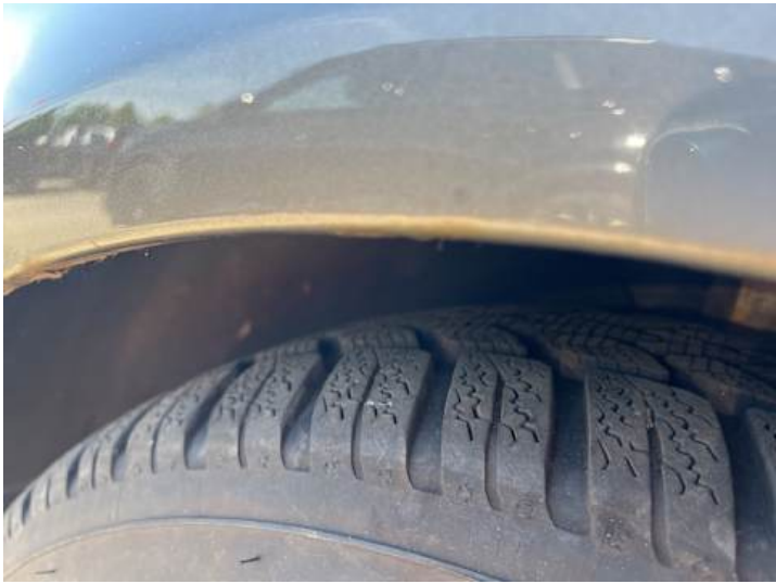
Kotflügel vorne links (Rost)
