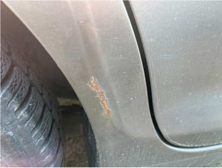
Seitenteil hinten rechts (Rost, Kratzer, Lackschaden)
