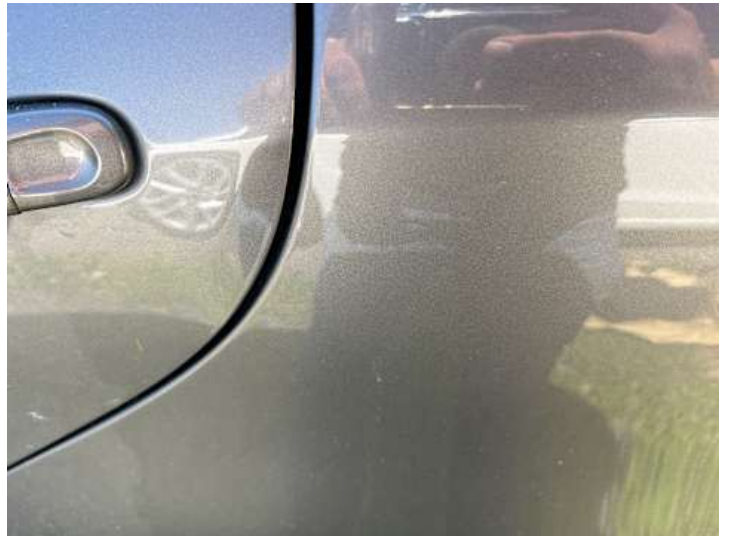
Türe hinten links (Delle, Verformung)
