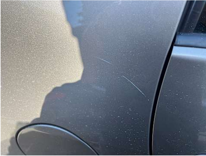
Seitenteil hinten rechts (Rost, Kratzer, Lackschaden)
