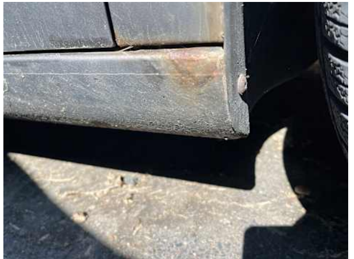
Schweller rechts (Rost)
