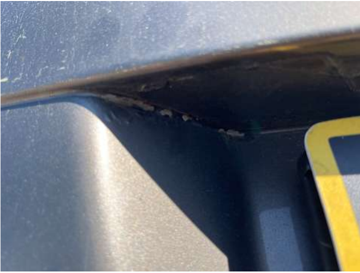
Heckklappe (Kratzer, Rost, Lackschaden)
