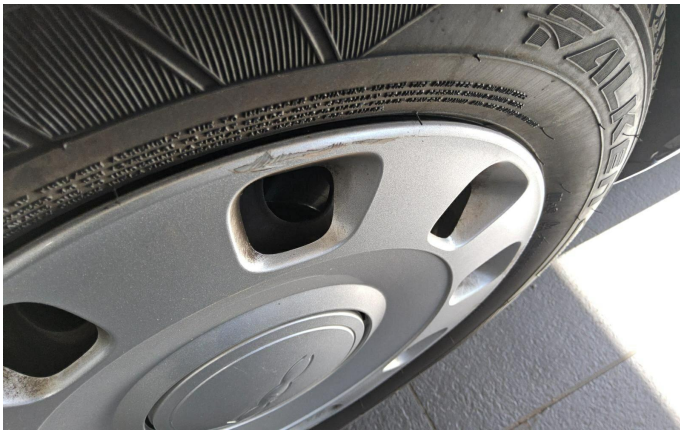
Bild 3: Außen, Felge vorne links - Radzierdeckel, zerkratzt, erneuern
