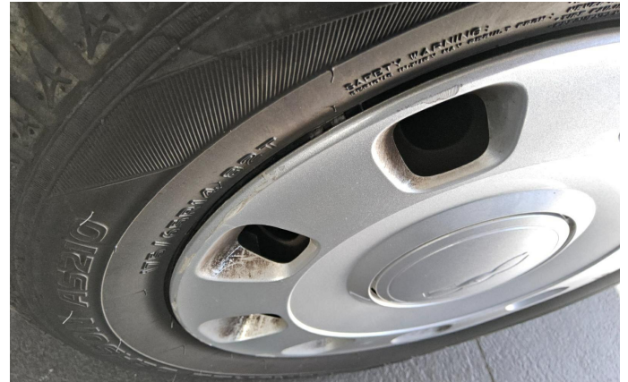
Bild 2: Außen, Felge vorne links - Radzierdeckel, zerkratzt, erneuern
