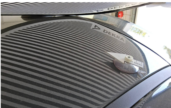
Bild 5: Außen, Dach, eingedellt, drücken
