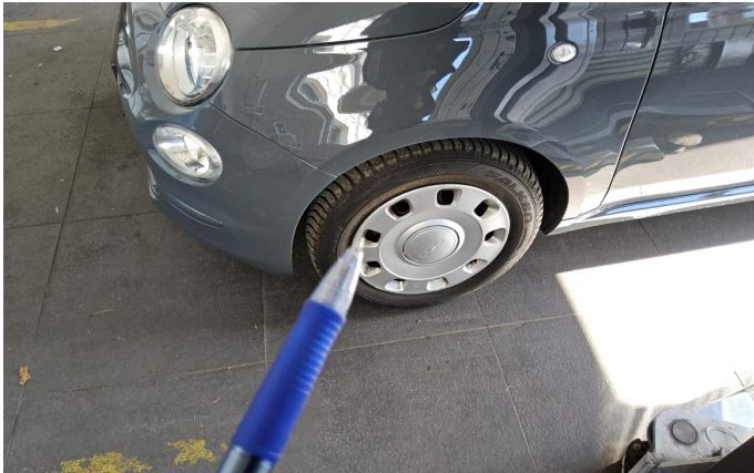
Bild 1: Außen, Felge vorne links - Radzierdeckel, zerkratzt, erneuern
