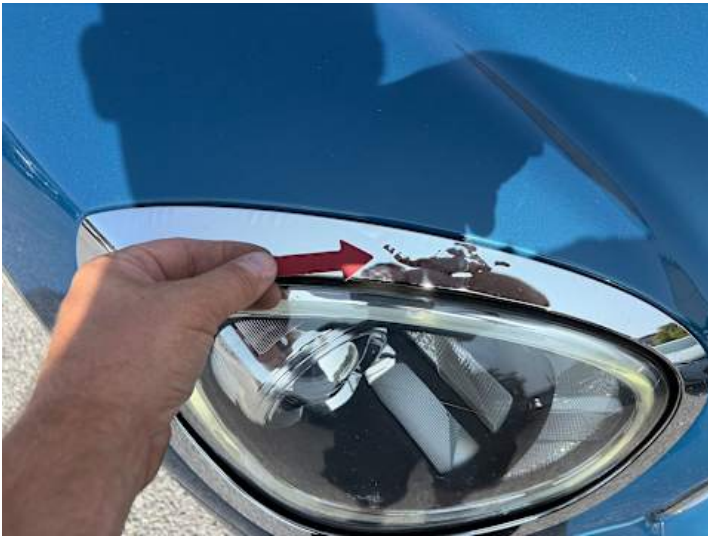
Scheinwerfer (rechts) (Anderer Schaden): Folie löst sich ;
