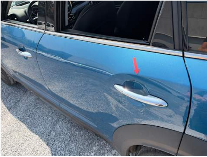
Türe hinten links (Kratzer)
