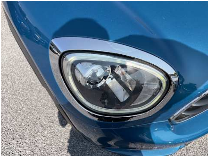
Scheinwerfer (rechts) (Anderer Schaden): Folie löst sich ;
