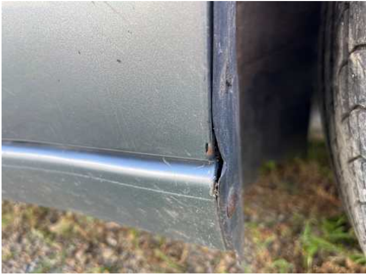
Kotflügel vorne rechts (Rost)
