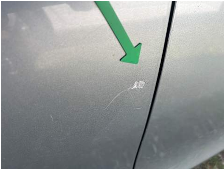
Türe hinten rechts (Delle, Lackschaden)
