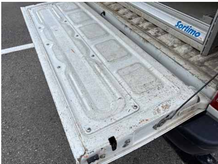
Heckklappe (Kratzer, Delle)
