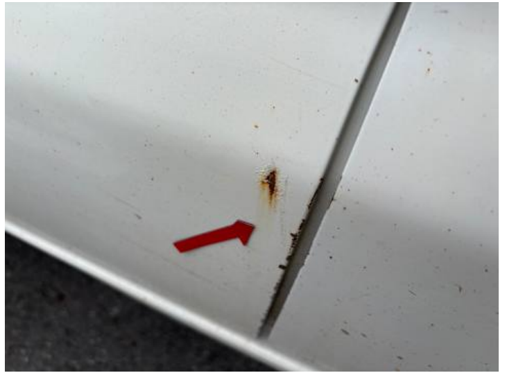
Türe hinten rechts (Rost)
