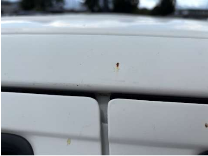
Seitenteil hinten rechts (Rost)
