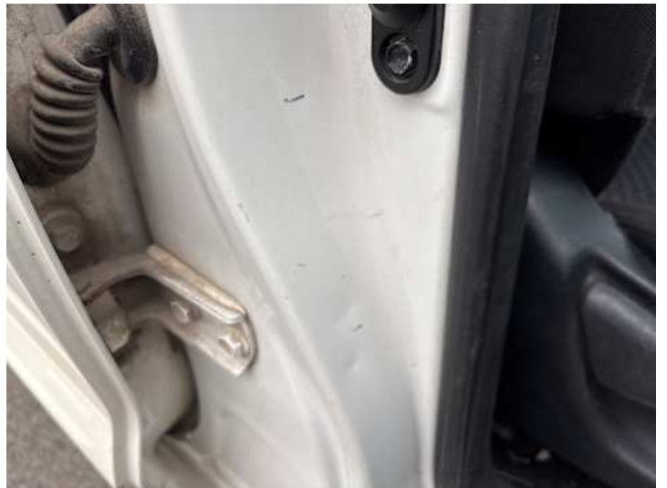
Beifahrtür (Delle, Lackschaden)
