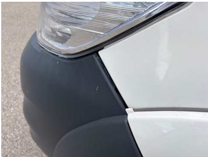
Stoßstange vorne (Spaltmaße ungenau)
