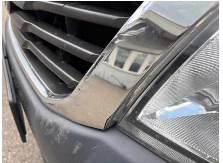
Stoßstange vorne (Riss/Bruch, Kratzer)
