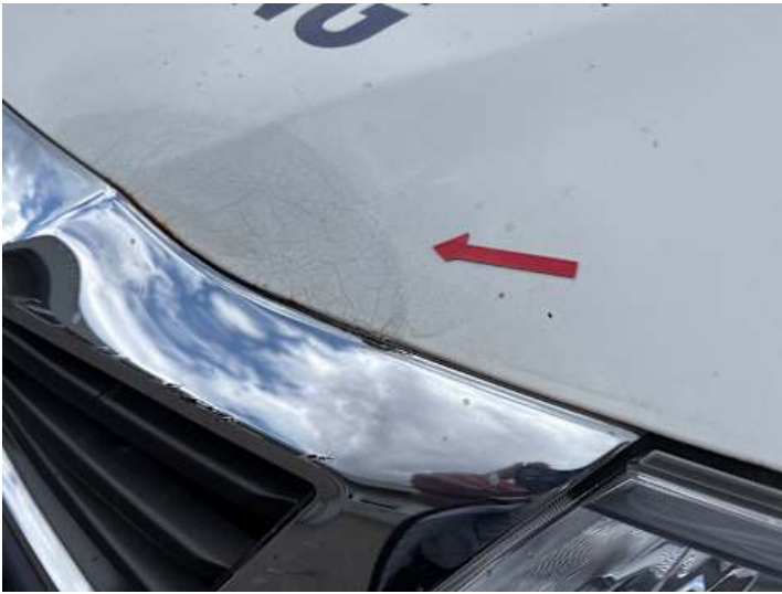
Motorhaube (Rost, Lackschaden, Unsachgemäß instand gesetzt)
