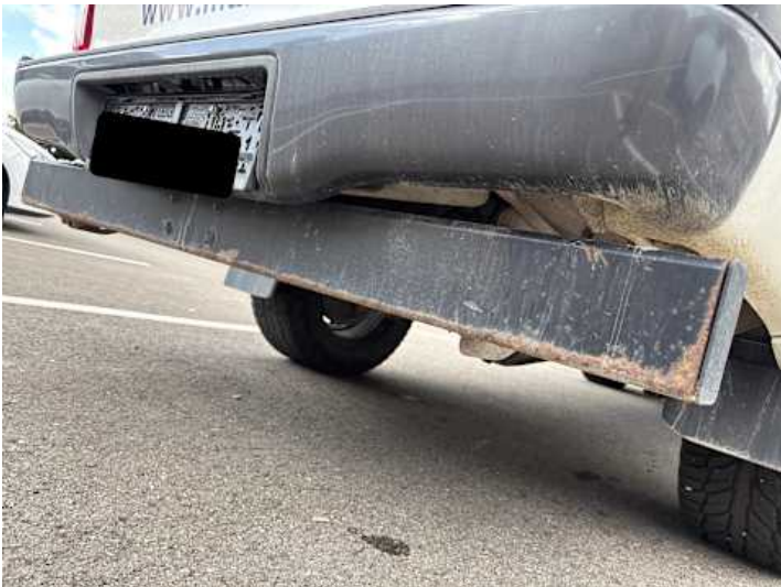
Stoßstange hinten (Rost)
