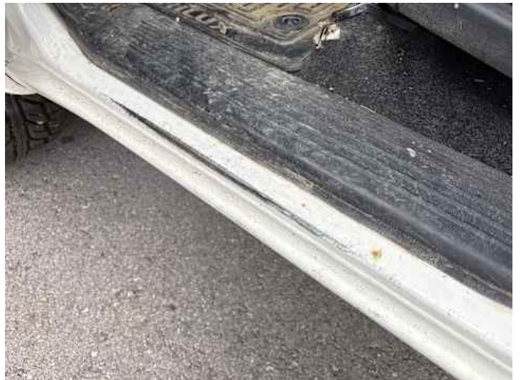
Schweller links (Kratzer)
