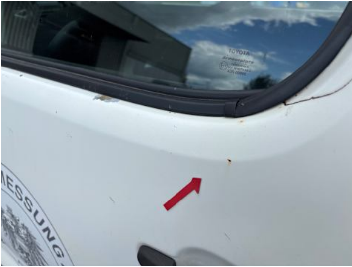
Türe hinten links (Rost, Lackschaden)
