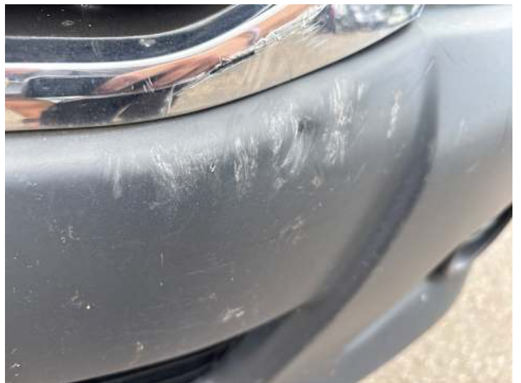
Stoßstange vorne (Kratzer, Verformung)
