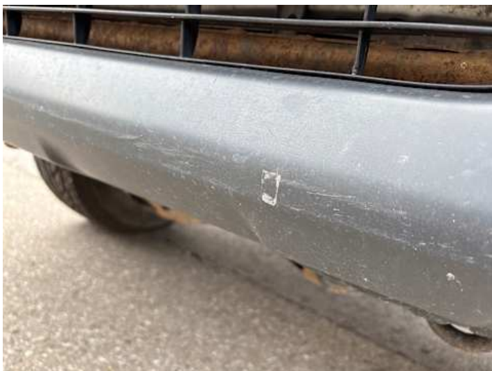
Stoßstange vorne (Kratzer, Verformung)
