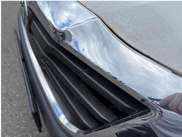
Stoßstange vorne (Riss/Bruch, Kratzer)
