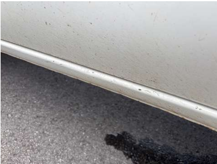
Schweller rechts (Lackschaden)
