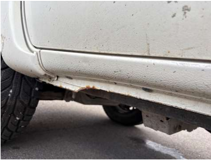
Schweller links (Rost)
