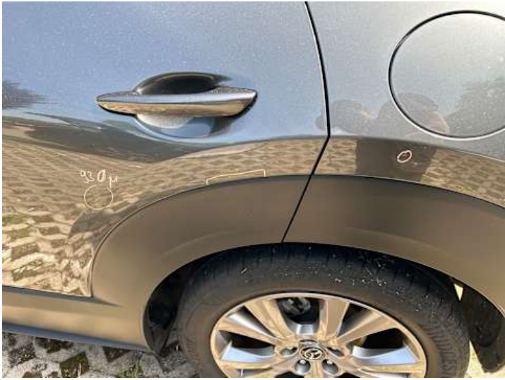
Türe hinten links (Lackschaden)
