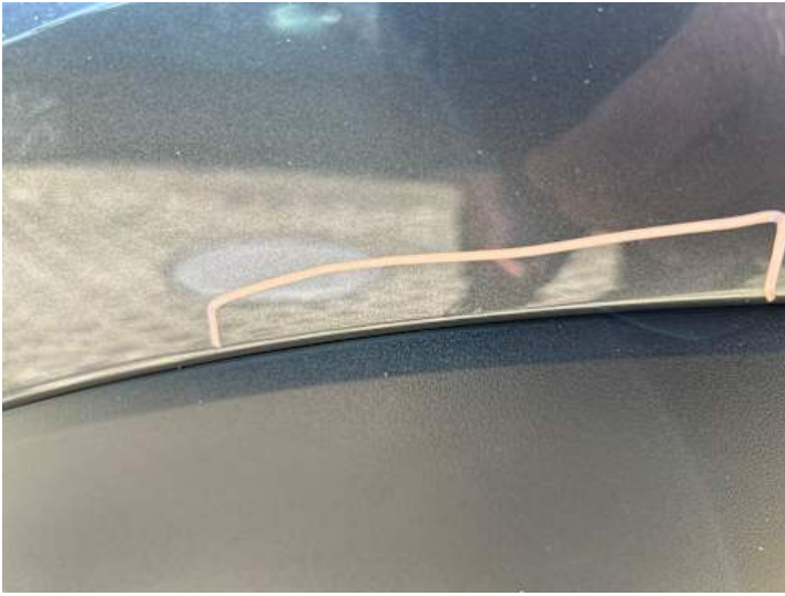
Türe hinten links (Lackschaden)
