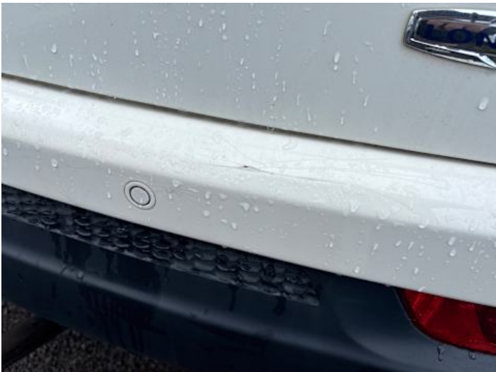
Stoßstange hinten (Riss/Bruch)
