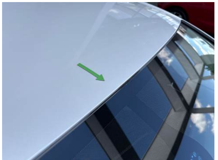
Windschutzscheibe (Anderer Schaden): An mehreren Stellen kommt der Kleber hervor
