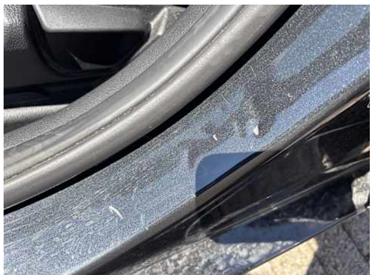
Schweller links (Delle, Kratzer)
