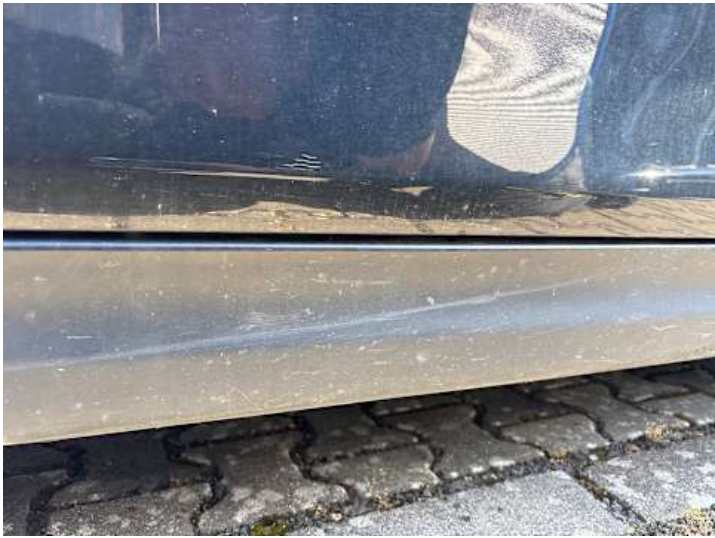
Schweller rechts (Kratzer)
