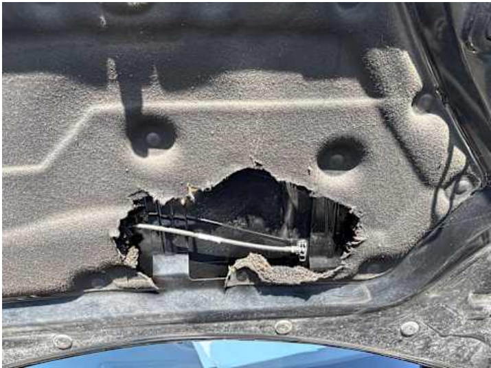
Motorhaube (Anderer Schaden): Marderschaden
