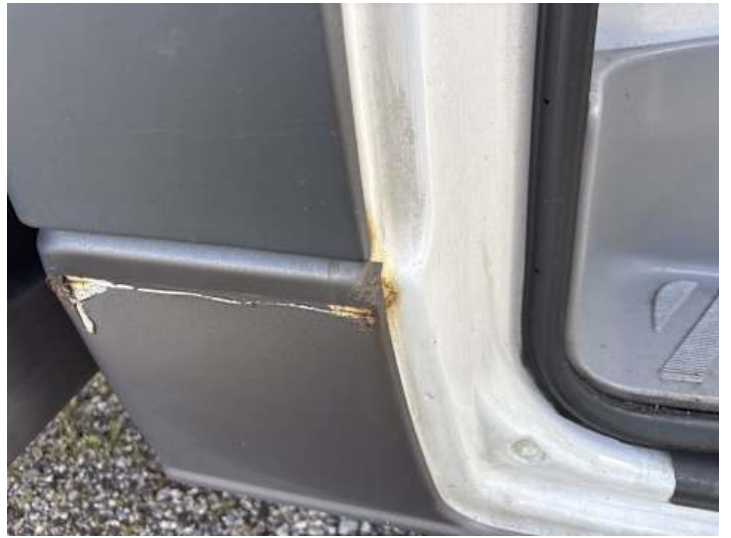
Schweller rechts (Rost)
