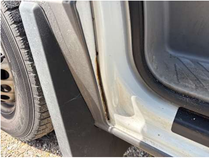
Schweller links (Rost)
