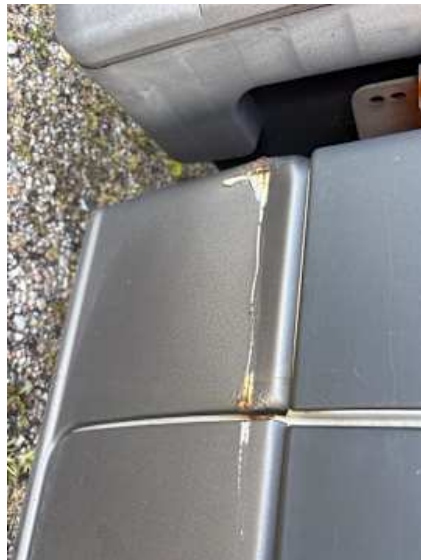
Seitenteil hinten rechts (Verformung, Kratzer, Rost)
