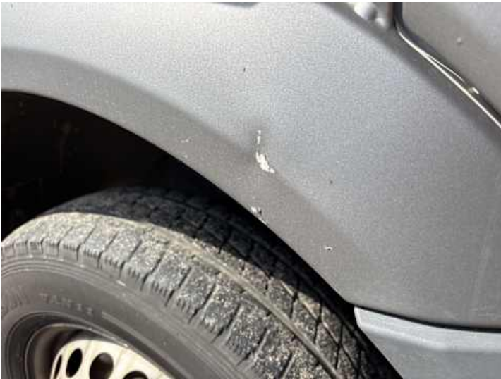
Kotflügel vorne links (Kratzer, Verformung)
