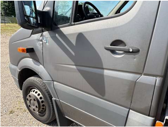
Fahrertür (Kratzer, Delle)
