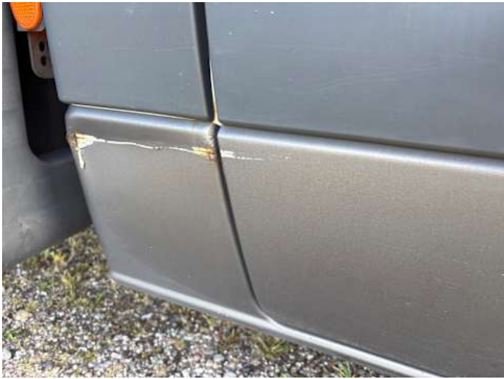
Beifahrertür (Kratzer, Verformung)
