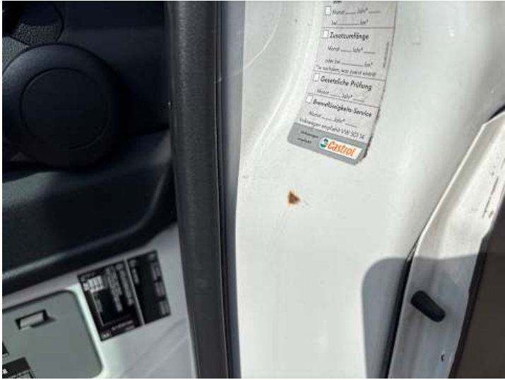
Schweller links (Rost)
