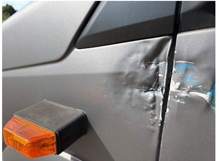
Kotflügel vorne links (Kratzer, Verformung)
