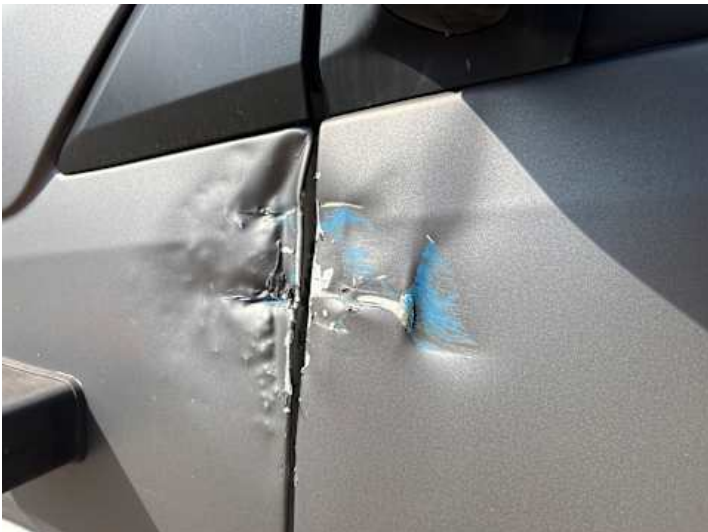
Fahrtür (Kratzer, Delle)
