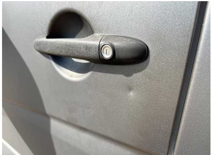
Fahrtür (Kratzer, Delle)
