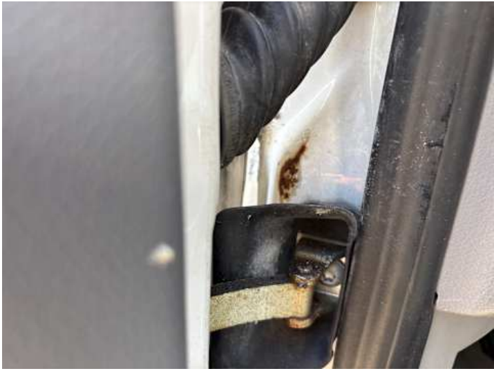
Schweller links (Rost)
