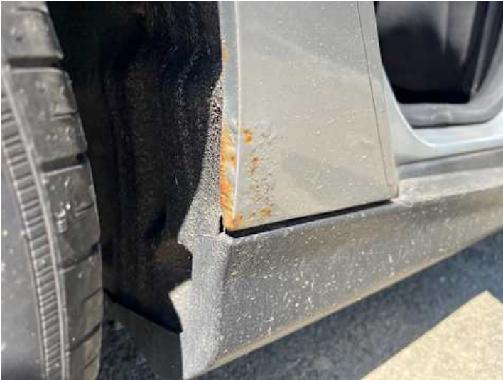
Seitenteil hinten rechts (Rost)
