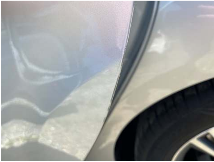
Türe hinten links (Lackschaden)
