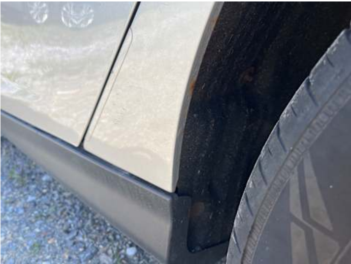
Seitenteil hinten links (Rost)
