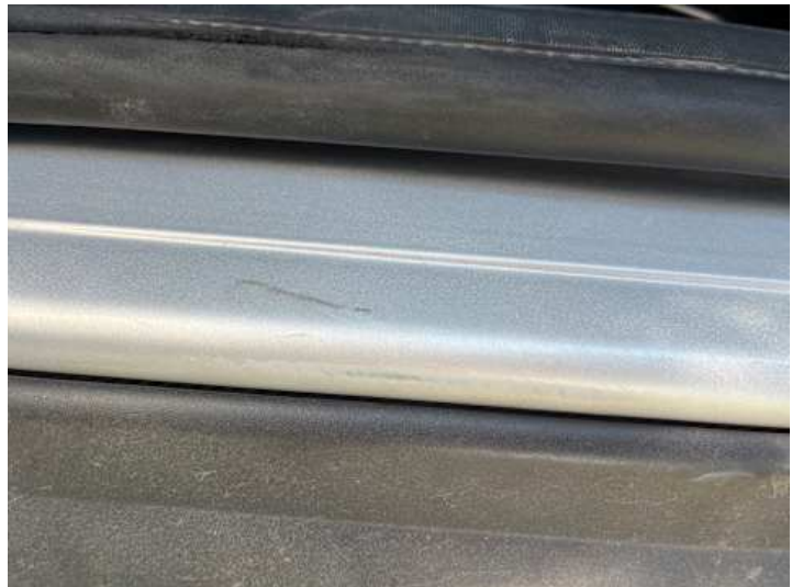
Schweller links (Kratzer)
