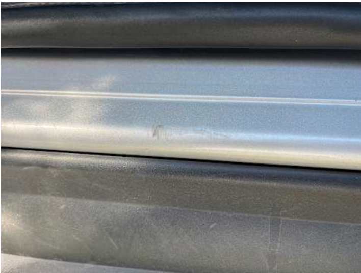
Schweller links (Kratzer)
