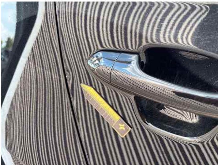
Türe hinten rechts (Verformung)
