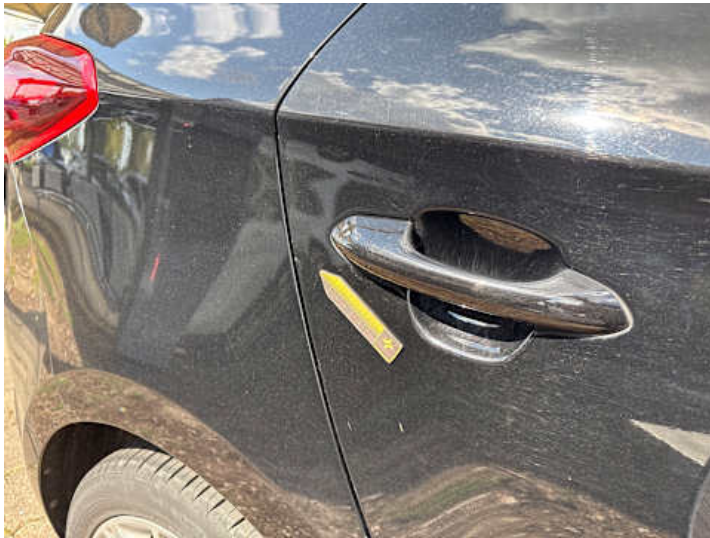
Türe hinten rechts (Verformung)
