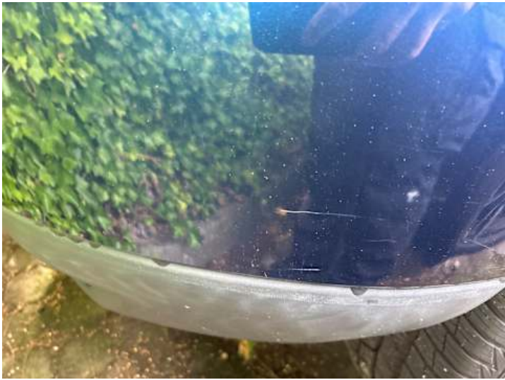
Stoßstange hinten (Kratzer)
