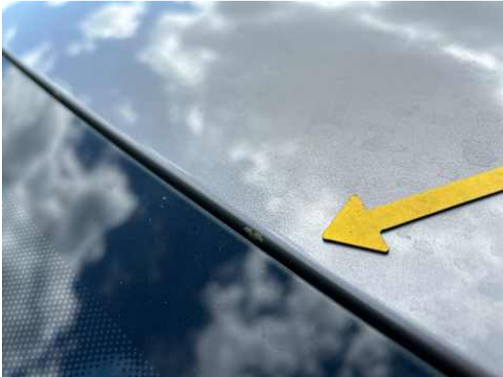
Dach (Lackschaden, Steinschlag)
