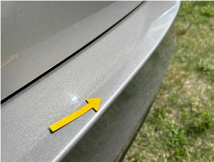
Stoßstange hinten (Kratzer)
