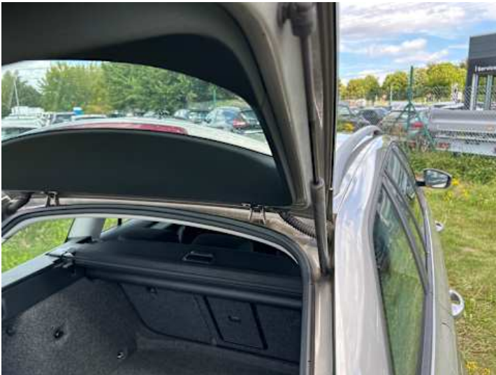
Heckklappe (Anderer Schaden): Heckklappendämpfer defekt
