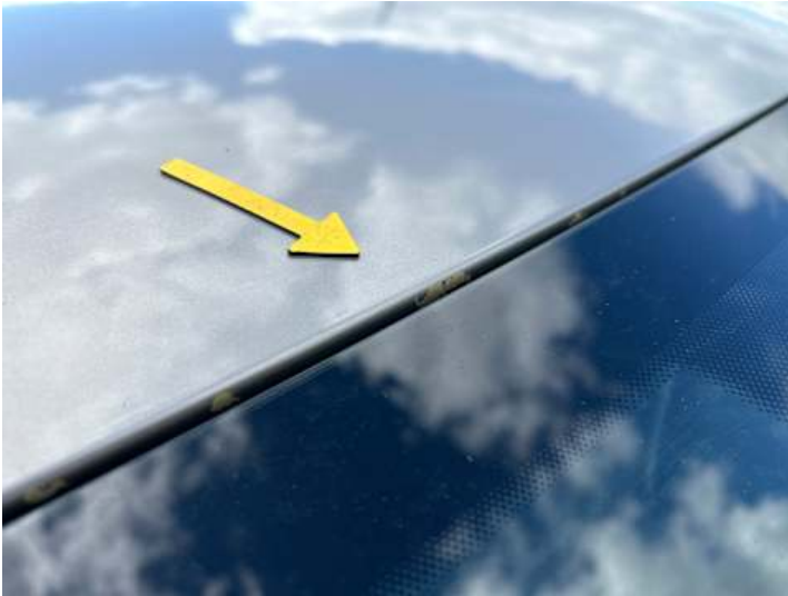
Dach (Lackschaden, Steinschlag)
