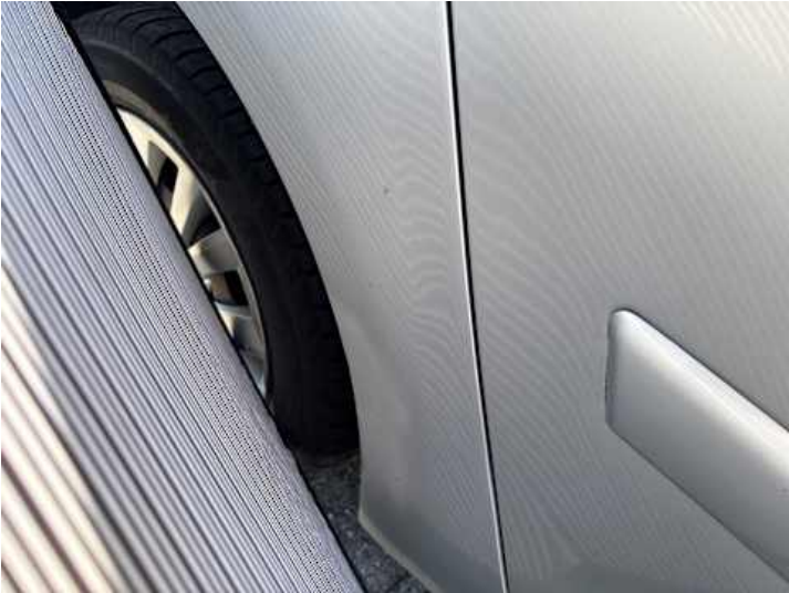
Seitenteil hinten rechts (Unsachgemäß instand gesetzt, Verformung)
