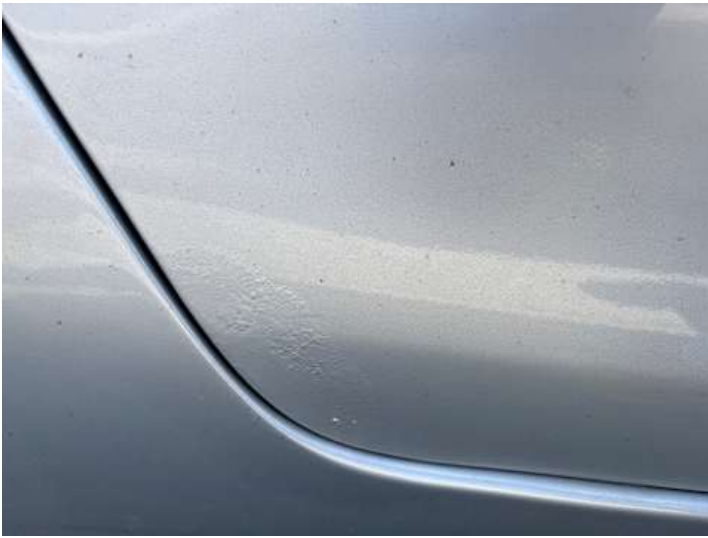
Türe hinten rechts (Rost, Unsachgemäß instand gesetzt)
