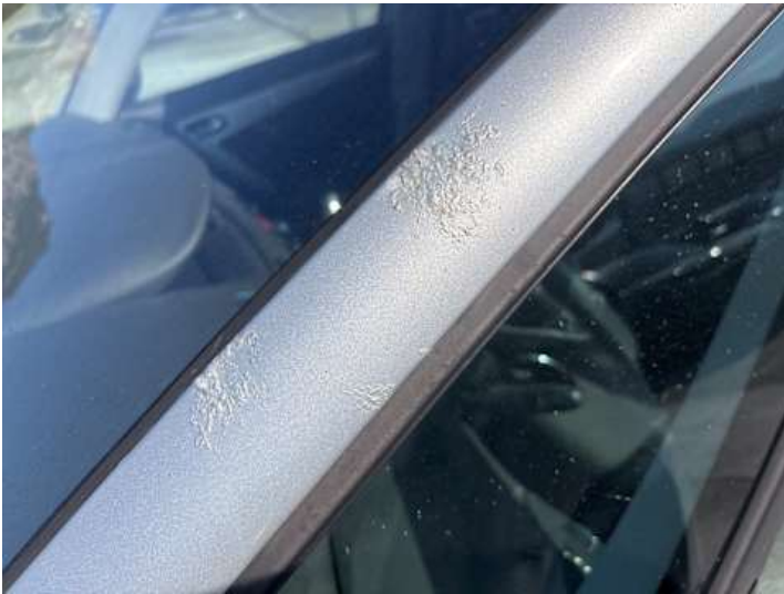
Seitenteil hinten links (Rost)
