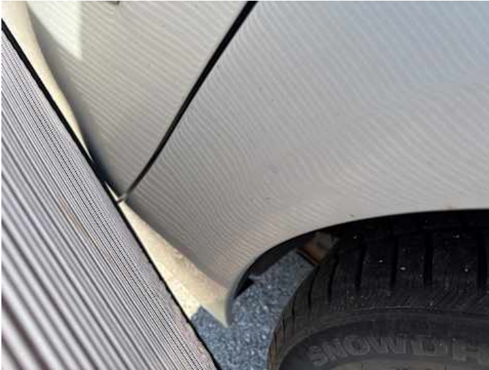
Seitenteil hinten links (Verformung)
