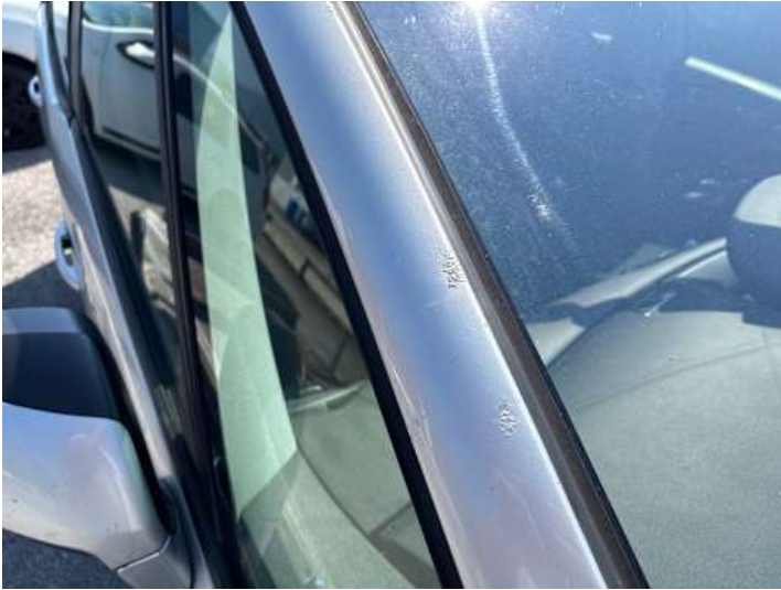
Seitenteil hinten rechts (Rost)
