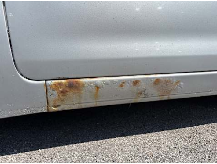
Schweller links (Rost)
