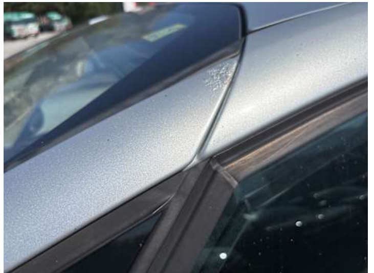
Seitenteil hinten links (Rost)
