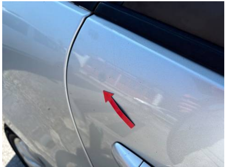
Türe hinten rechts (Unsachgemäß instand gesetzt)
