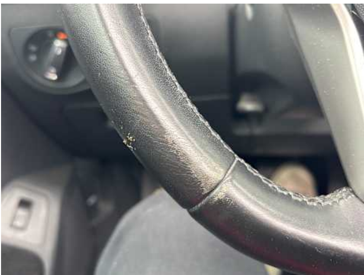
Innenraum (Kratzer, Verschleiß)
