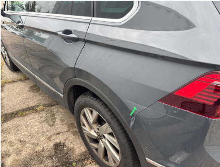
Seitenteil hinten links (Kratzer, Lackschaden, Rost, Verformung)
