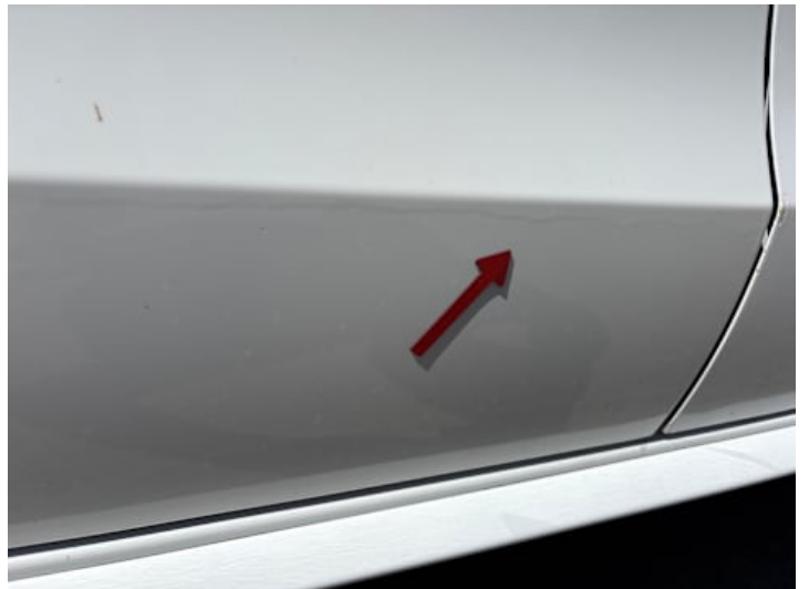
Türe hinten rechts (Unsachgemäß instand gesetzt)
