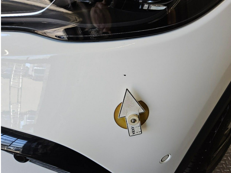
Bild 21 : Stoßfänger vorne Steinschläge
