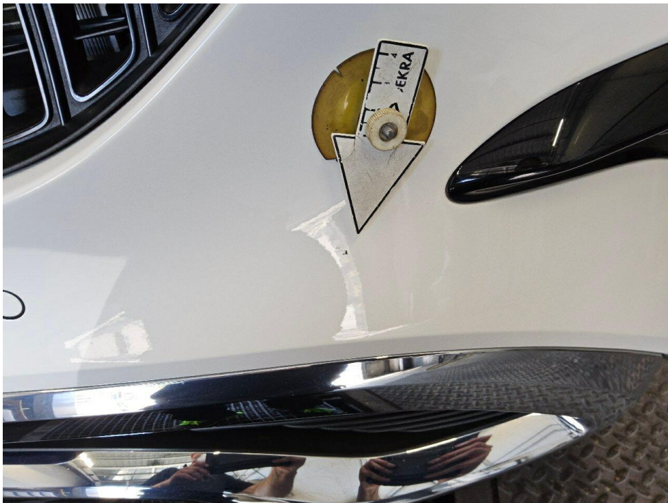
Bild 22 : Stoßfänger vorne Steinschläge
