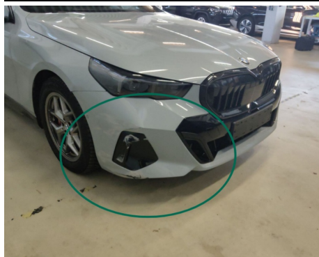
Stoßfänger / Vorne Rechts / Gebrochen
