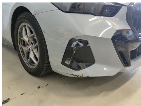
Stoßfänger / Vorne Rechts / Gebrochen
