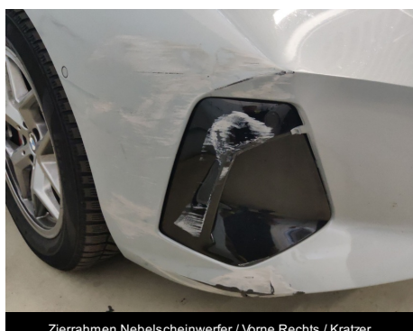
Zierrahmen Nebelscheinwerfer / Vorne Rechts / Kratzer
