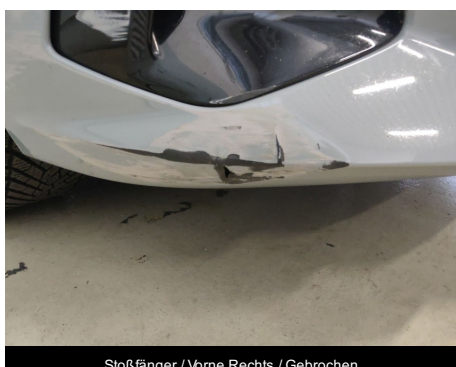
Stoßfänger / Vorne Rechts / Gebrochen
