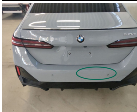
Stoßfänger / Hinten / Kratzer
