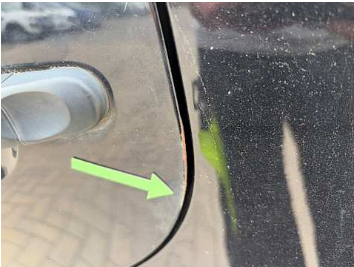
Türe hinten links (Rost)
