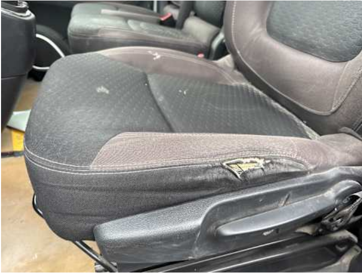
Innenraum (Riss/Bruch, Verschleiß)
