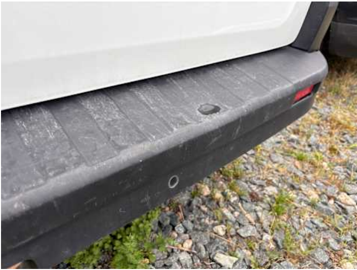
Stoßstange hinten (Verformung)
