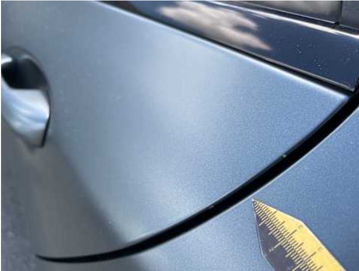
Türe hinten links (Kratzer)
