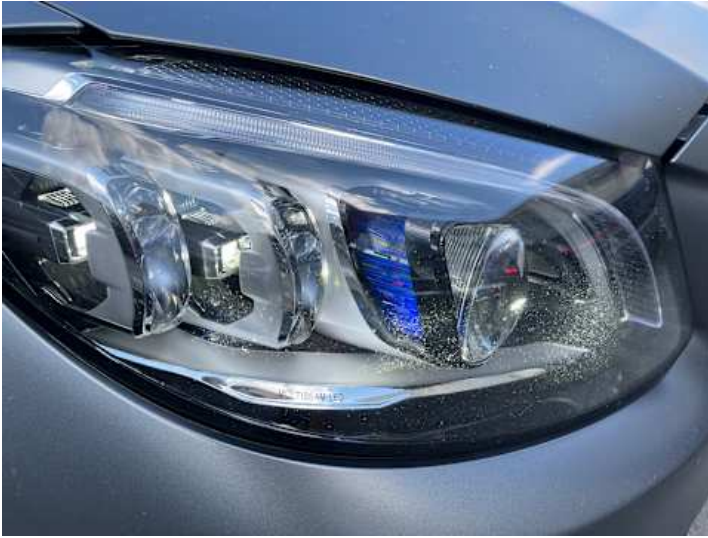
Scheinwerfer (rechts) (Steinschlag)
