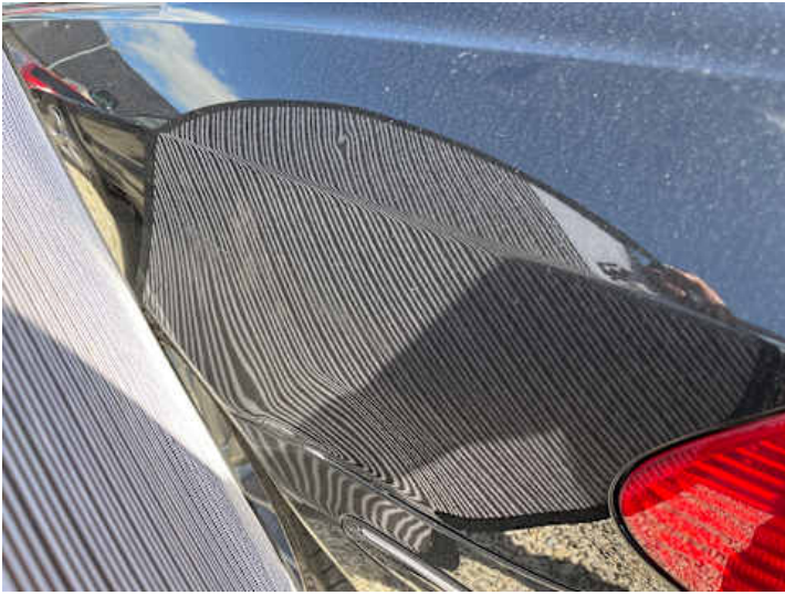
Seitenteil hinten links (Verformung, Kratzer)
