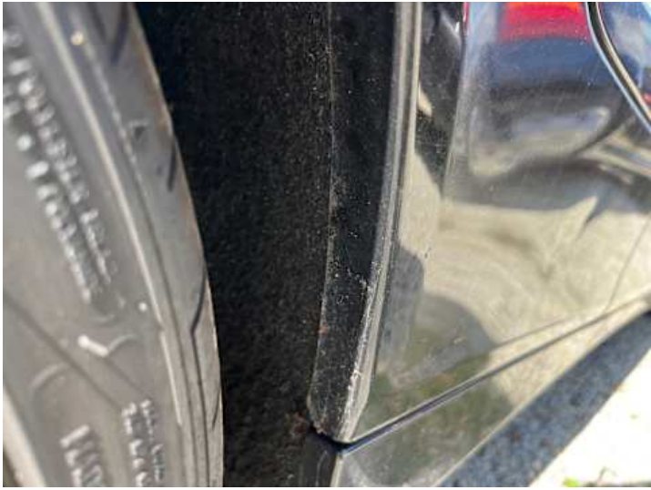
Seitenteil hinten rechts (Rost)
