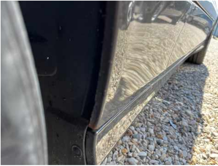
Kotflügel vorne links (Rost)
