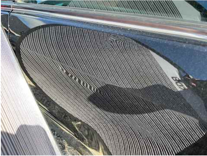
Seitenteil hinten links (Verformung, Kratzer)
