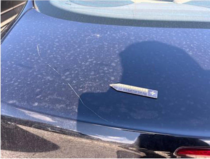
Heckklappe (Verformung, Kratzer)
