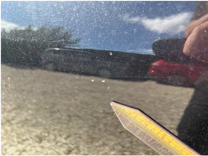
Seitenteil hinten rechts (Kratzer)
