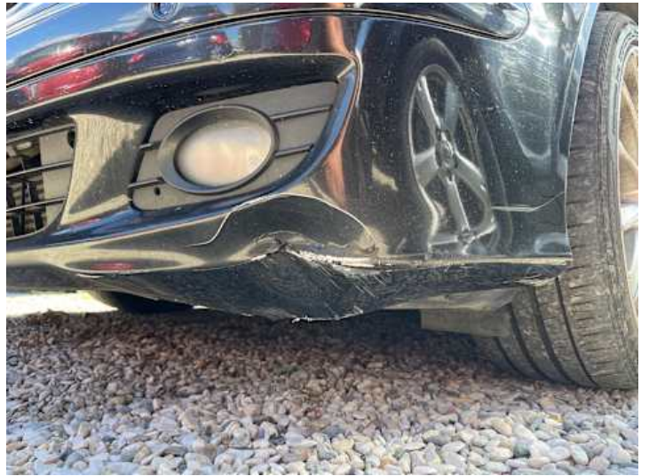
Stoßstange vorne (Verformung, Kratzer, Riss/Bruch)
