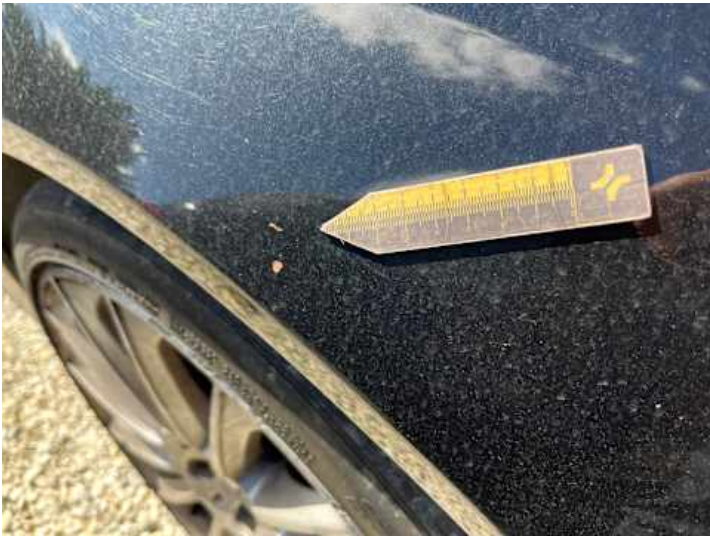
Kotflügel vorne rechts (Steinschlag, Rost)
