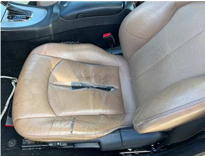
Innenraum (Diverse Schäden, Verschleiß)
