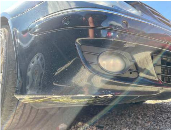
Stoßstange vorne (Verformung, Kratzer, Riss/Bruch)
