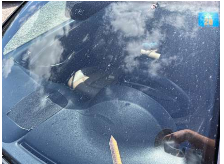
Windschutzscheibe (Steinschlag, Riss/Bruch)
