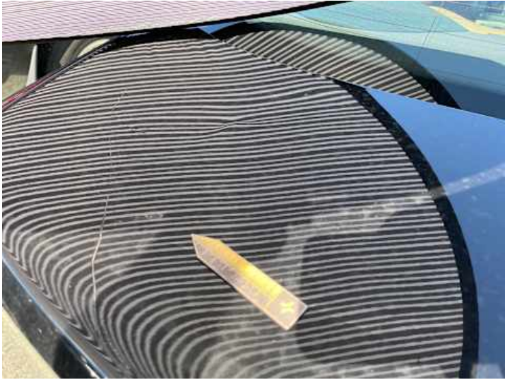
Heckklappe (Verformung, Kratzer)
