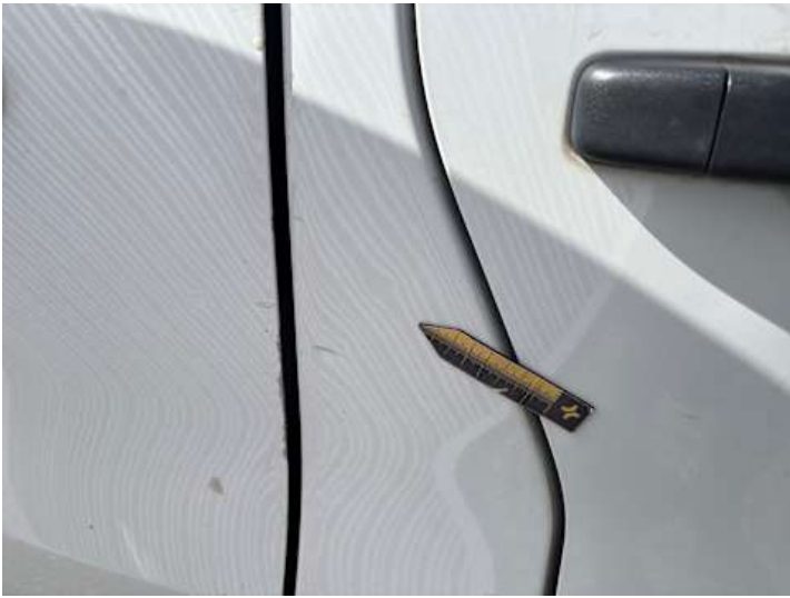
Schweller rechts (Delle)
