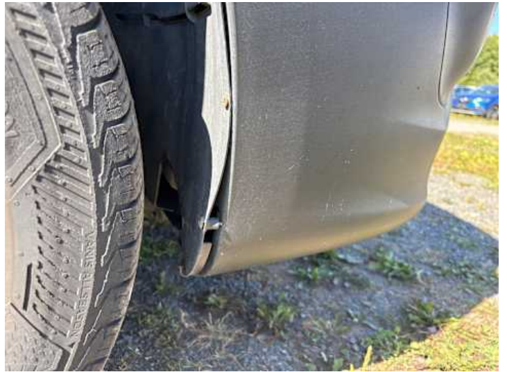
Stoßstange vorne (Spaltmaße ungenau)
