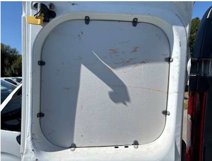
Innenraum (Diverse Schäden, Anderer Schaden, Verschmutzung): Korrosion
