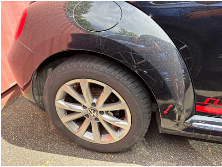
Seitenteil hinten rechts (Rost, Verformung, Unsachgemäß instand gesetzt)
