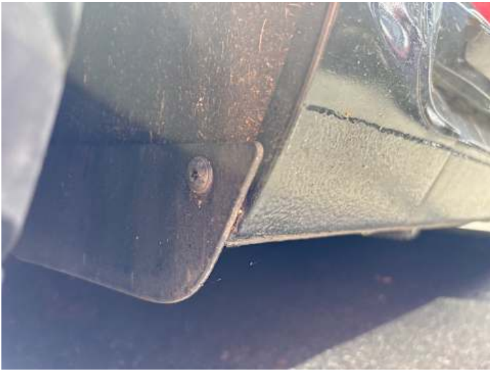
Schweller rechts (Rost)
