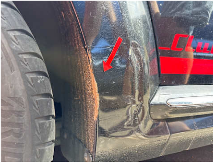
Seitenteil hinten rechts (Rost, Verformung, Unsachgemäß instand gesetzt)
