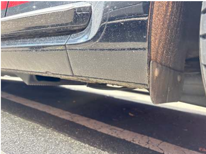
Schweller links (Rost)
