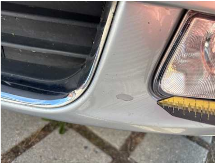
Stoßstange vorne (Lackschaden)
