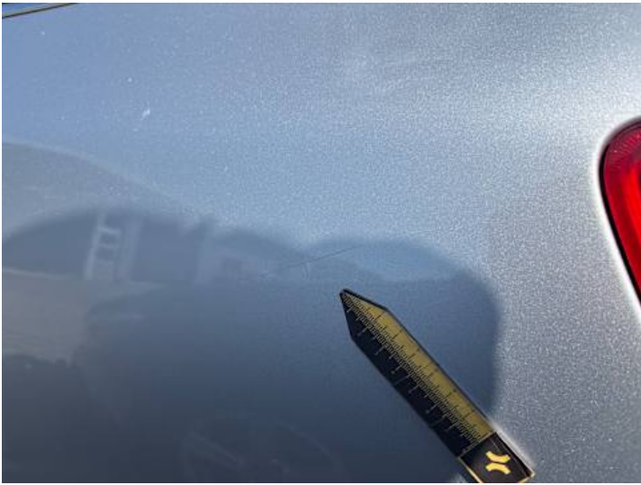
Seitenteil hinten links (Kratzer)
