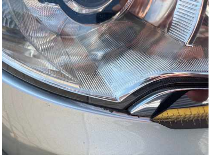
Stoßstange vorne (Lackschaden)
