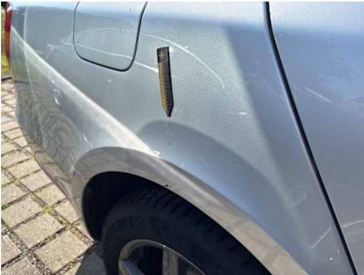
Seitenteil hinten rechts (Delle)
