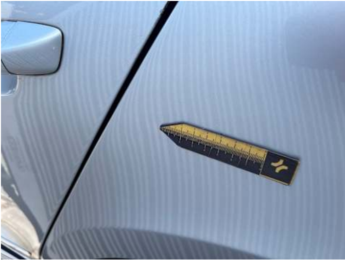
Seitenteil hinten links (Delle)
