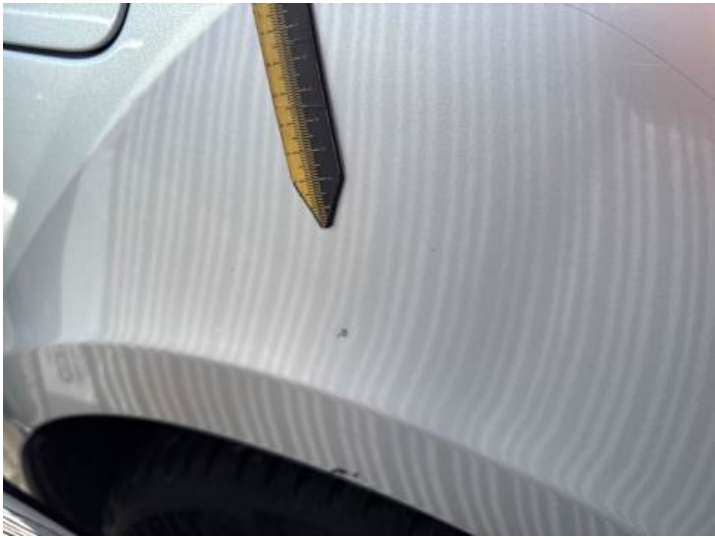
Seitenteil hinten rechts (Delle)
