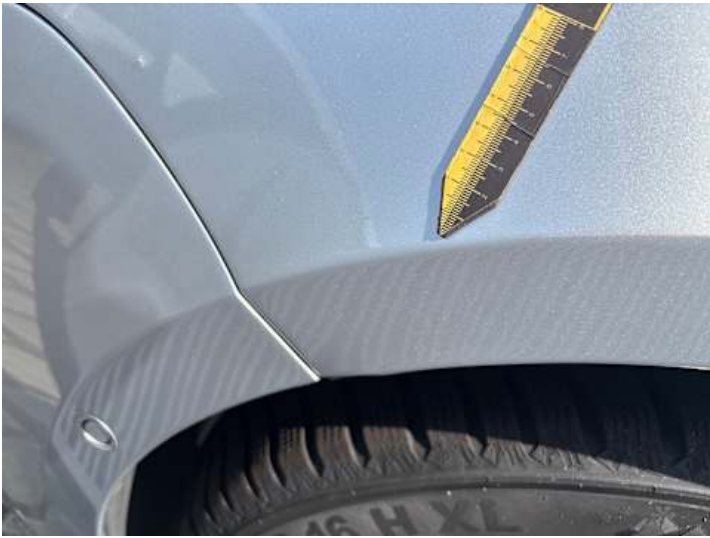
Kotflügel vorne links (Verformung)
