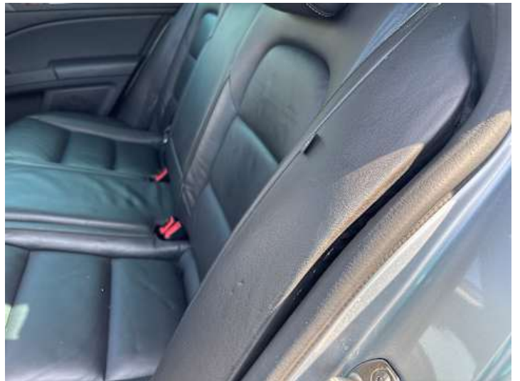
Innenraum (Anderer Schaden): Verkleidung lose
