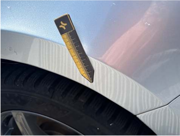
Kotflügel vorne rechts (Verformung)
