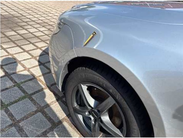
Kotflügel vorne links (Verformung)
