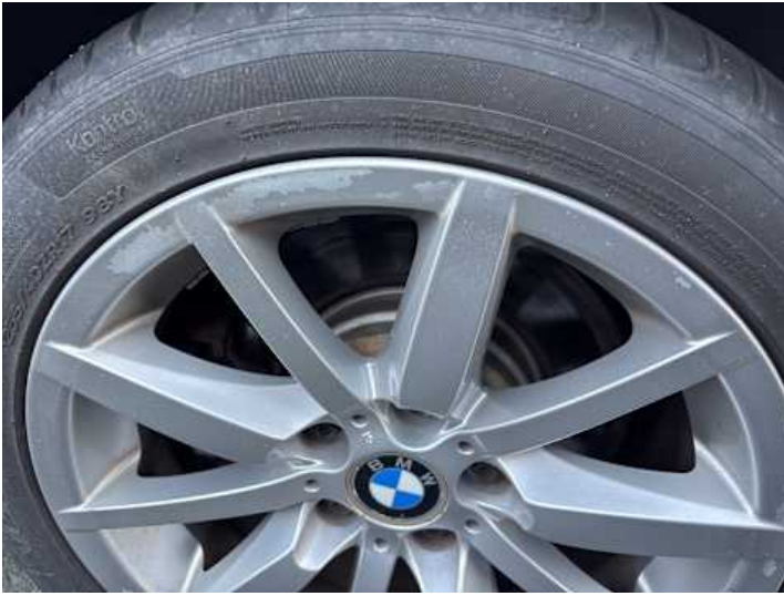
Rad (Anderer Schaden): Lackschaden
