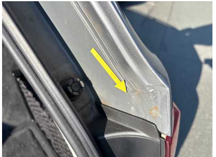
Seitenteil hinten rechts (Rost)
