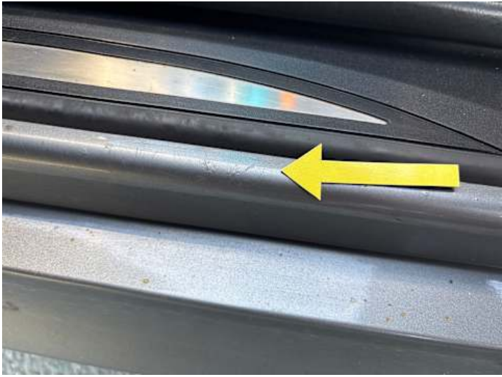
Schweller links (Rost)
