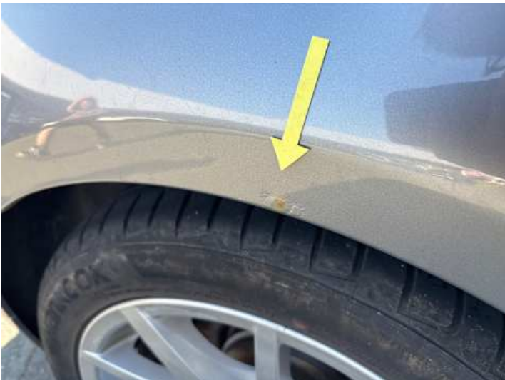
Seitenteil hinten rechts (Rost)
