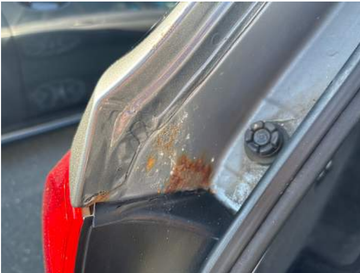
Seitenteil hinten links (Rost)
