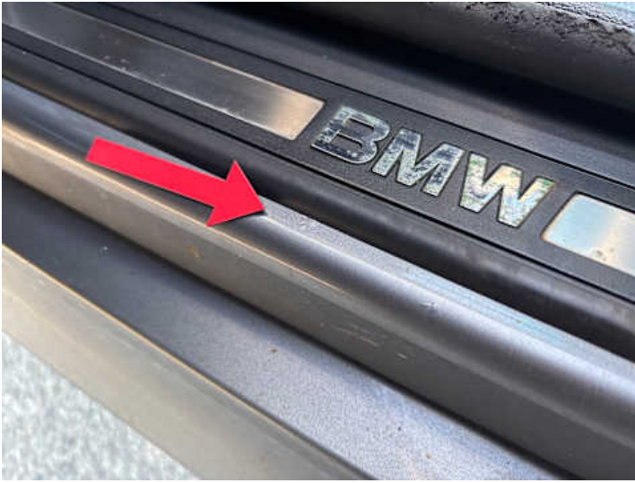
Schweller links (Rost)
