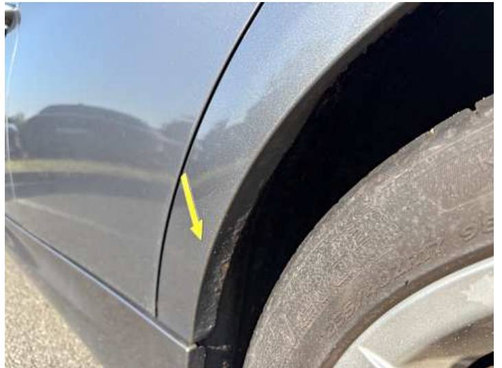
Seitenteil hinten links (Rost, Verformung)
