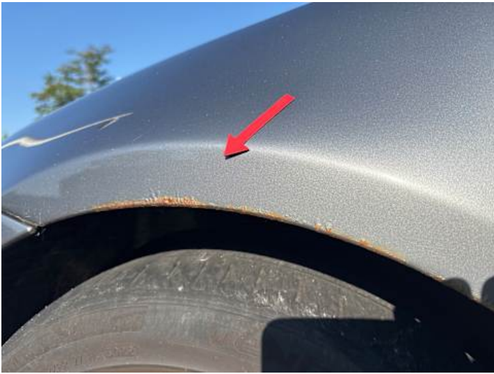
Kotflügel vorne links (Rost)
