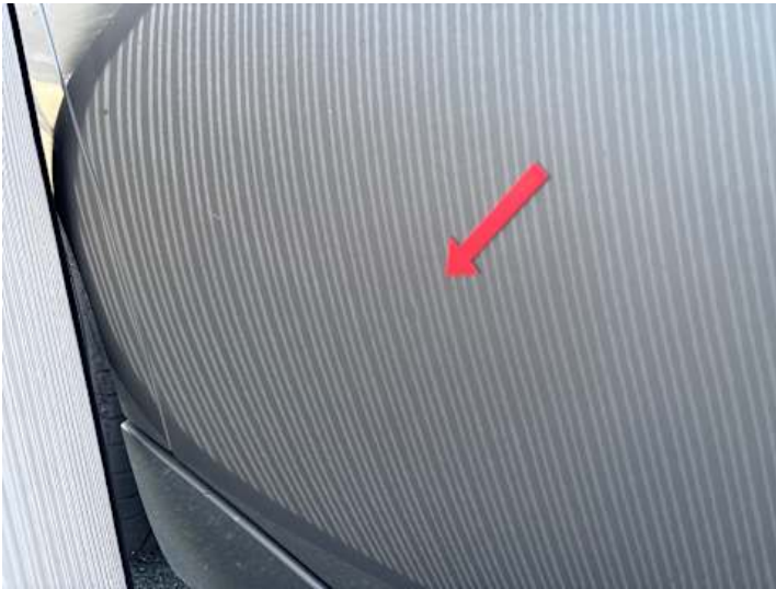
Türe hinten rechts (Delle)
