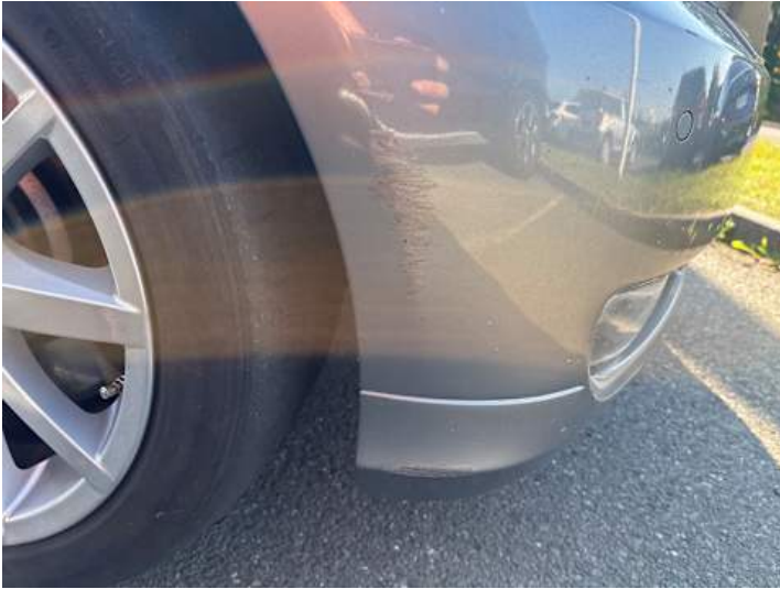
Stoßstange vorne (Kratzer, Lackschaden)
