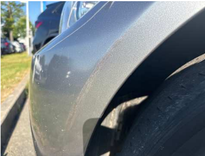
Stoßstange vorne (Lackschaden, Unsachgemäß instand gesetzt)
