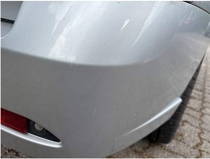
Stoßstange hinten (Kratzer)
