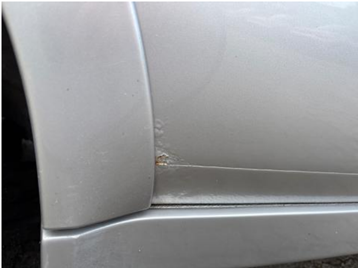
Türe hinten rechts (Rost, Lackschaden)
