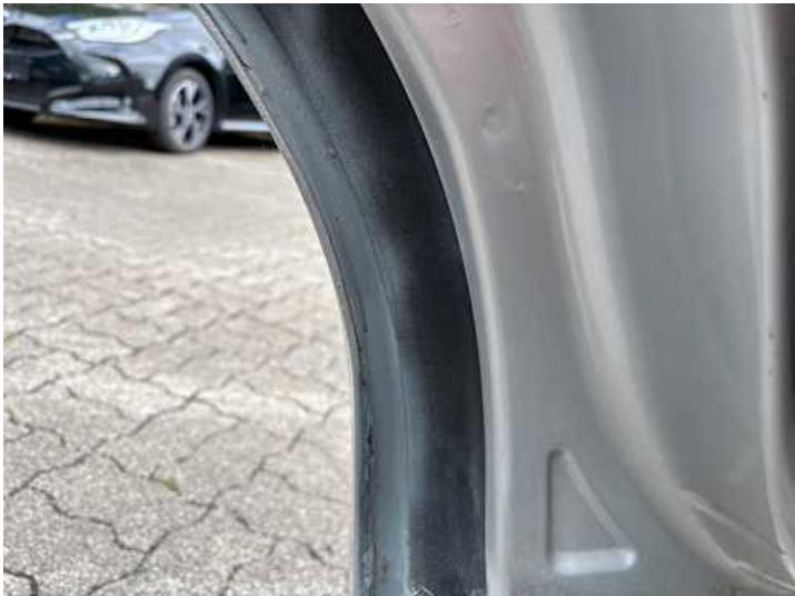
Türe hinten links (Rost, Lackschaden)
