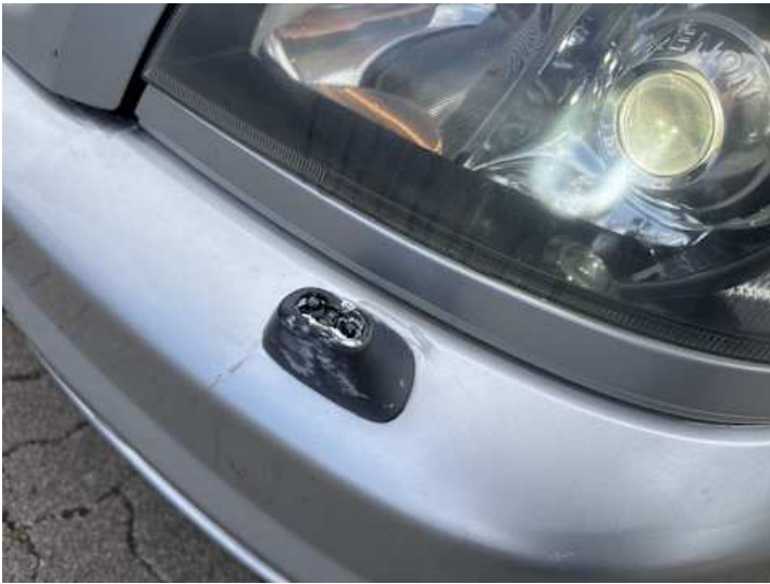
Stoßstange vorne (Lackschaden)
