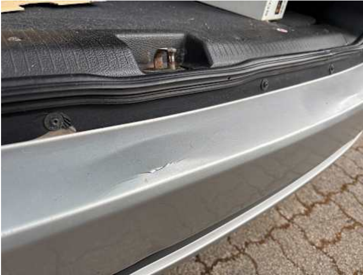
Stoßstange hinten (Riss/Bruch, Verformung)
