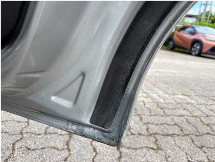
Türe hinten rechts (Rost, Lackschaden)
