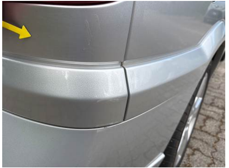
Stoßstange hinten (Kratzer)
