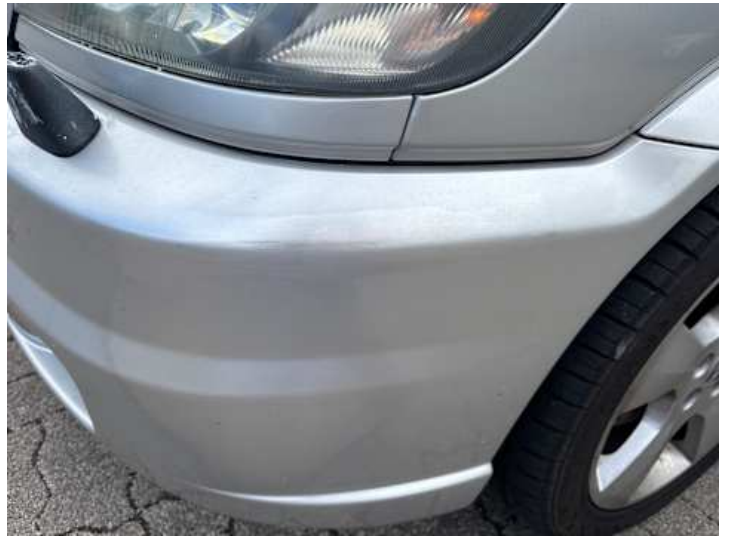
Stoßstange vorne (Unsachgemäß instand gesetzt)
