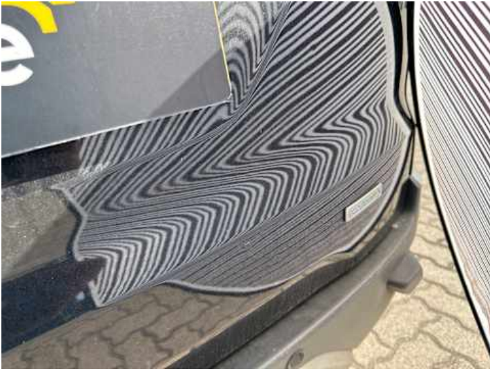
Heckklappe (Delle, Kratzer)
