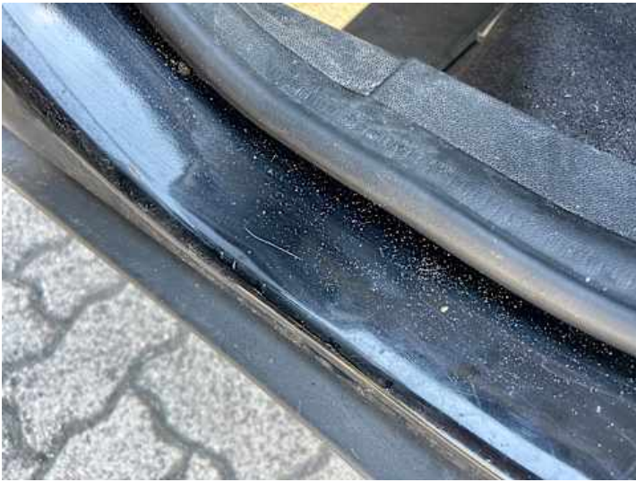
Schweller links (Kratzer)
