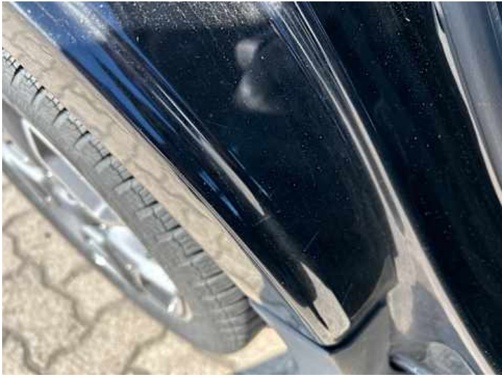
Türe hinten rechts (Kratzer, Delle)
