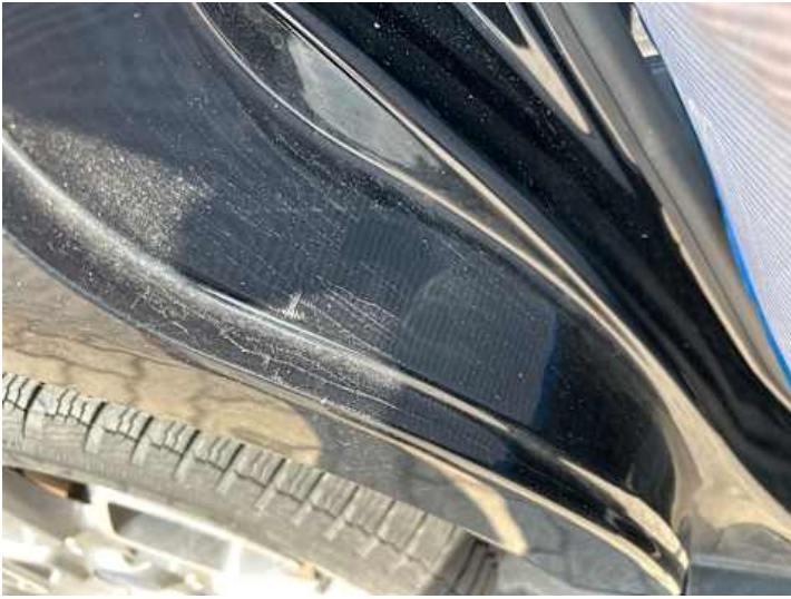
Türe hinten rechts (Kratzer, Delle)
