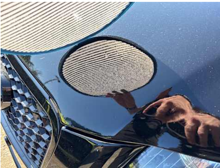
Motorhaube (Lackschaden, Anderer Schaden, Delle): Nachlackierung ersichtlich
