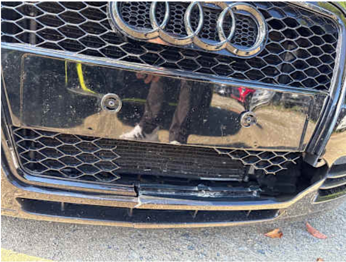
Stoßstange vorne (Riss/Bruch)
