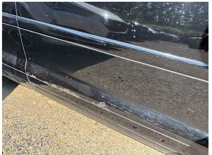
Beifahrtür (Kratzer, Lackschaden, Rost)
