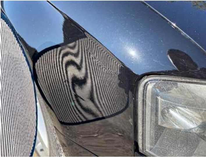
Kotflügel vorne rechts (Lackschaden, Anderer Schaden): Nachlackierung ersichtlich
