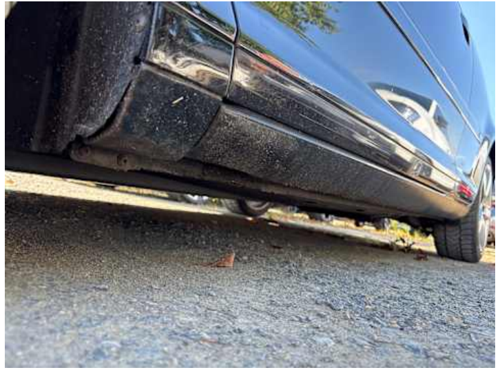
Schweller links (Delle)
