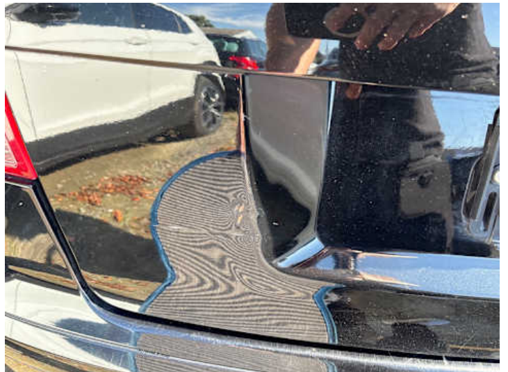
Heckklappe (Delle, Lackschaden, Kratzer, Rost)
