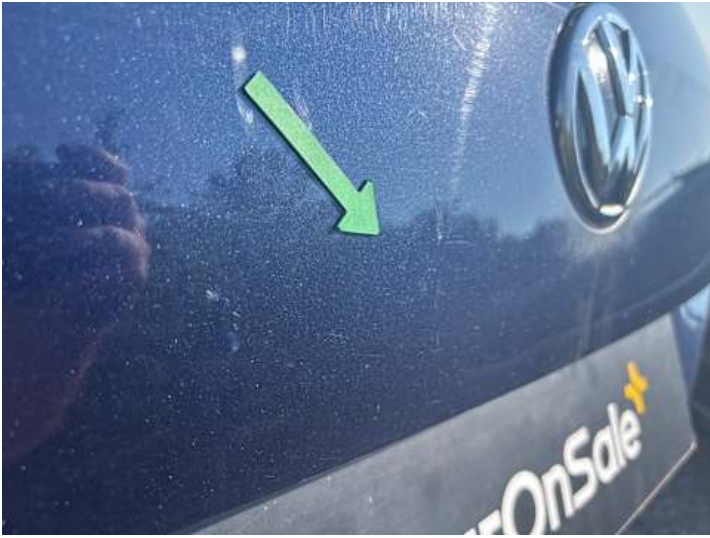
Heckklappe (Kratzer, Lackschaden, Unsachgemäß instand gesetzt)
