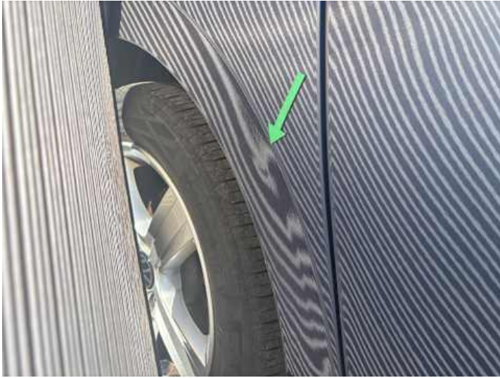
Seitenteil hinten rechts (Kratzer, Verformung)
