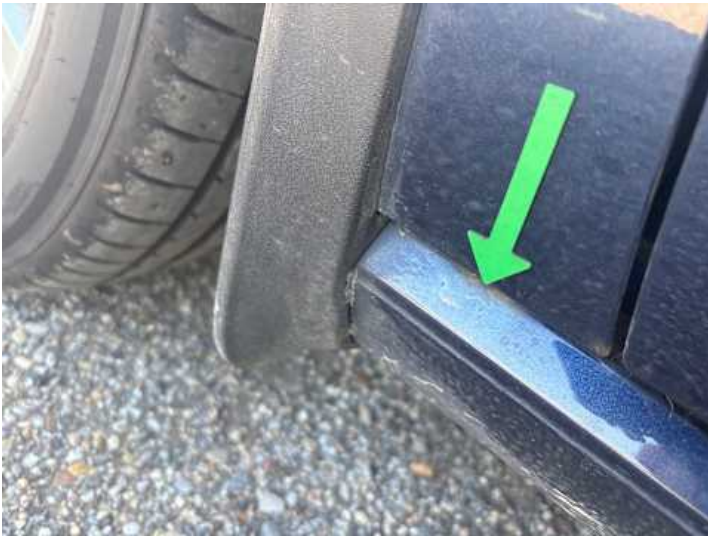
Schweller links (Rost)
