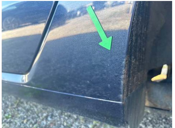
Seitenteil hinten links (Rost)
