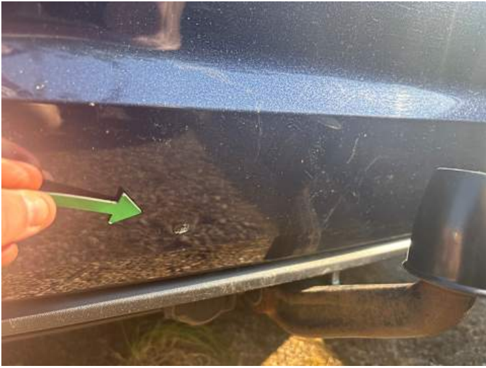
Stoßstange hinten (Kratzer, Verformung)
