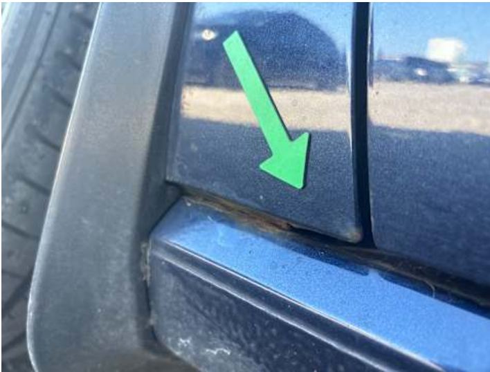
Kotflügel vorne links (Rost)
