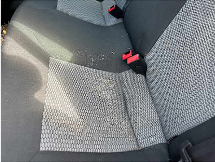
Innenraum (Anderer Schaden): Schimmelbildung
