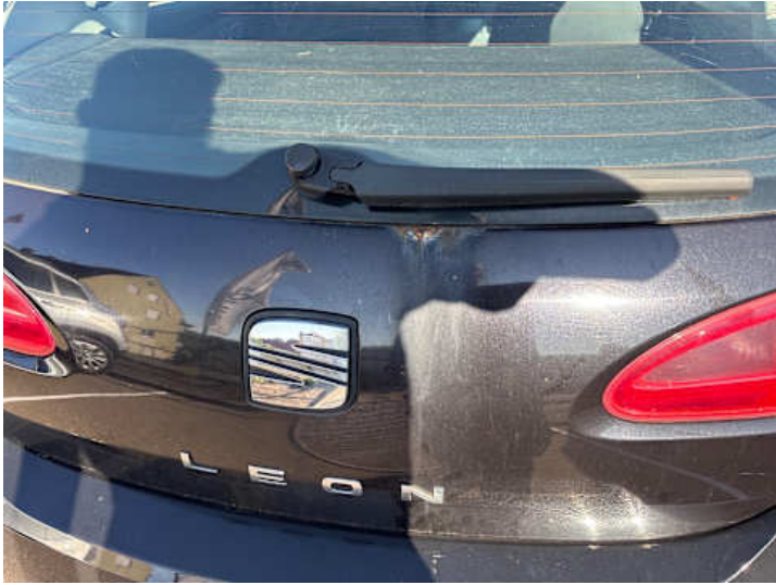
Heckklappe (Rost, Anderer Schaden): Öffnet nicht
