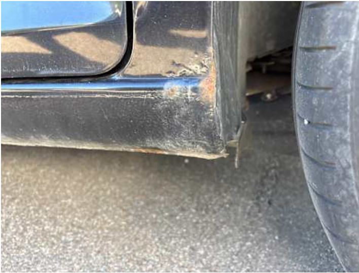
Schweller links (Rost)
