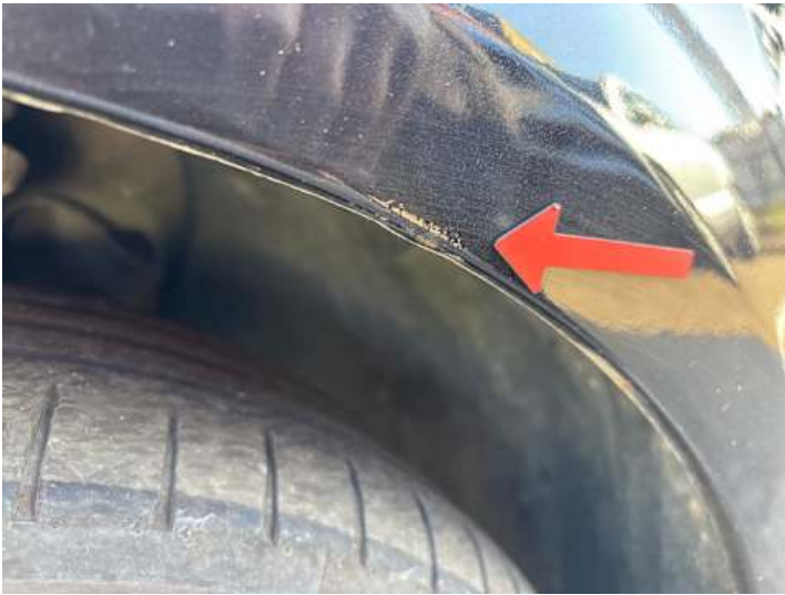
Kotflügel vorne links (Lackschaden, Delle, Ausgeblichen/Matt, Rost)
