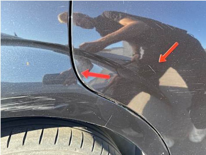
Türe hinten rechts (Delle, Kratzer, Rost)
