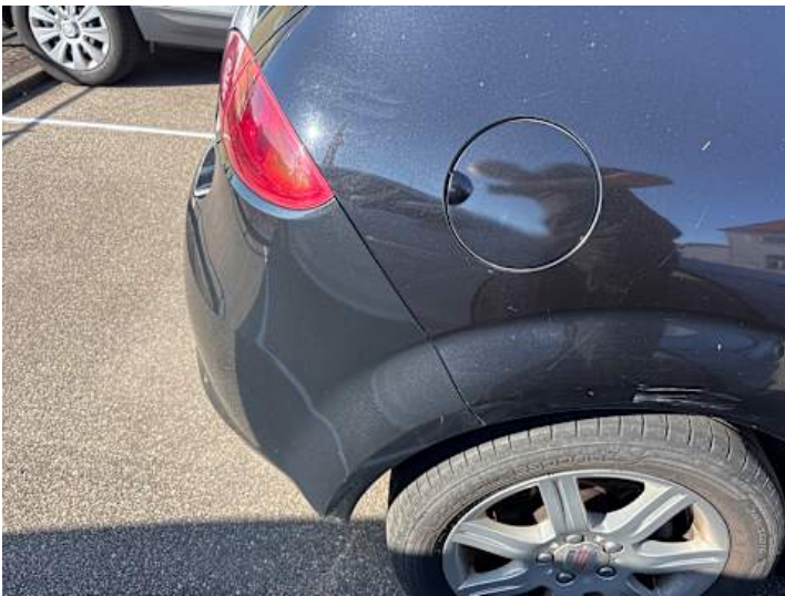
Stoßstange hinten (Anderer Schaden, Kratzer): Farbton unterschied
