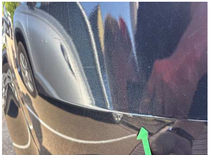
Stoßstange hinten (Anderer Schaden, Kratzer): Farbton unterschied
