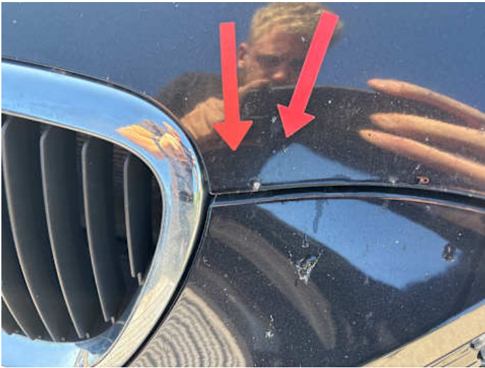
Motorhaube (Delle, Kratzer, Rost, Steinschlag)
