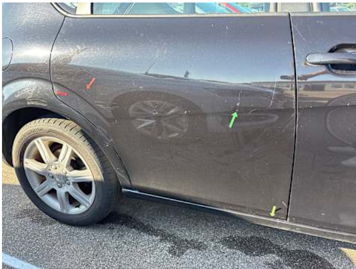
Türe hinten rechts (Delle, Kratzer, Rost)
