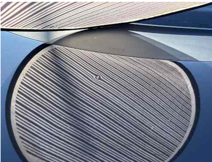
Motorhaube (Delle, Kratzer, Rost, Steinschlag)
