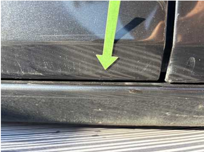
Türe hinten rechts (Delle, Kratzer, Rost)
