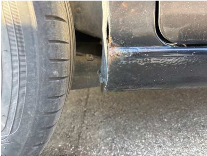
Schweller rechts (Rost)
