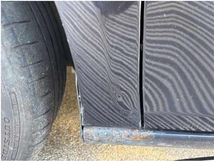
Kotflügel vorne links (Lackschaden, Delle, Ausgeblichen/Matt, Rost)
