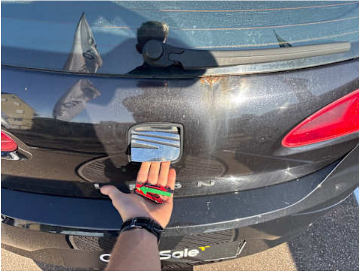
Heckklappe (Rost, Anderer Schaden): Öffnet nicht
