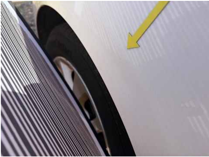
Seitenteil hinten rechts (Delle)
