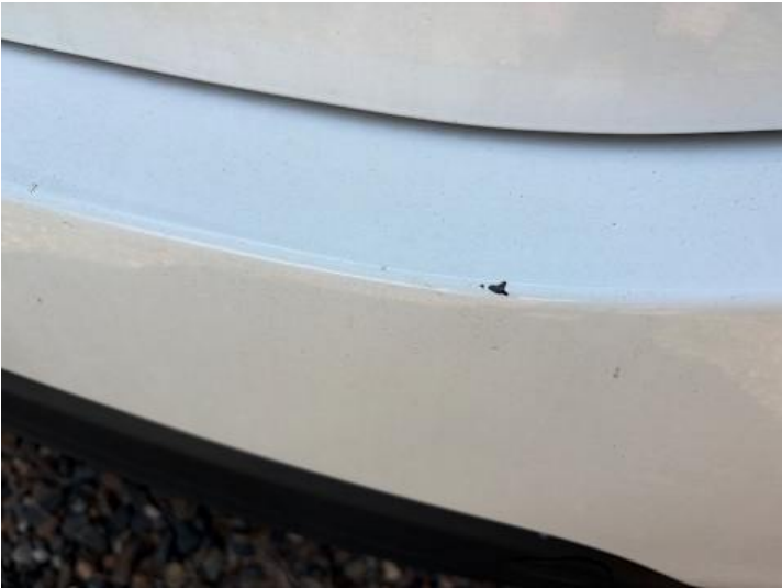
Stoßstange hinten (Lackschaden)
