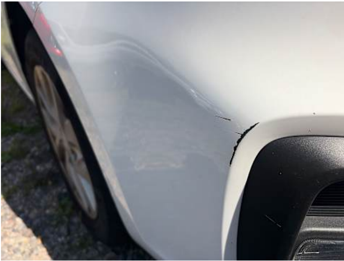
Stoßstange vorne (Lackschaden)
