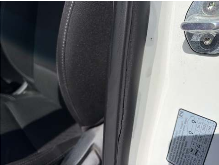
Fahrtür (Anderer Schaden): Türdichtung eingerissen
