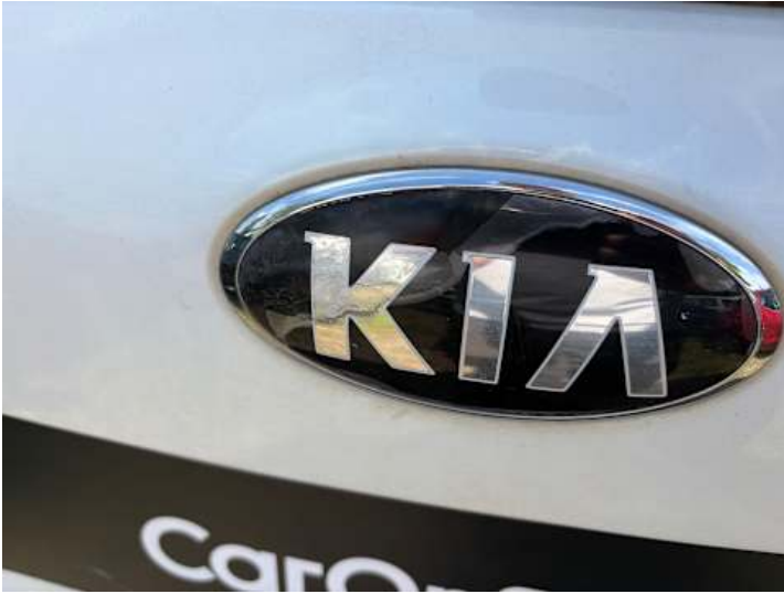
Heckklappe (Anderer Schaden): Beschichtung löst sich
