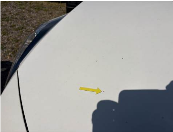
Motorhaube (Lackschaden, Rost)
