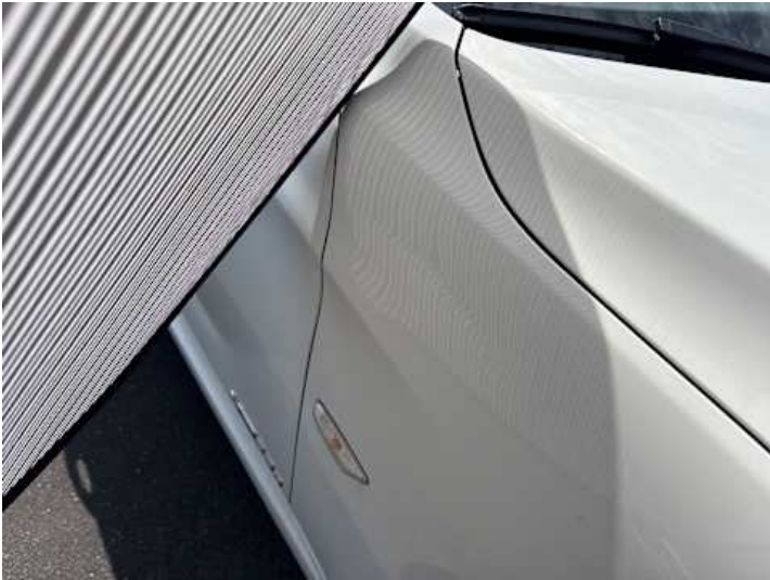
Kotflügel vorne rechts (Verformung)
