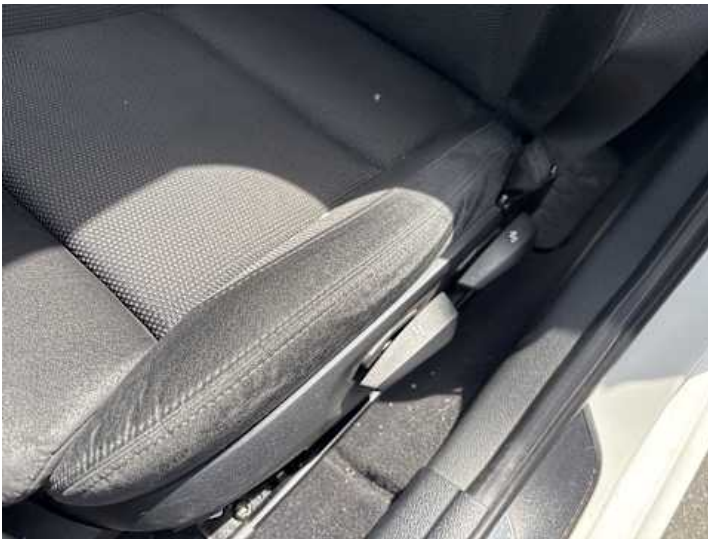
Innenraum (Verschmutzung, Verschleiß)
