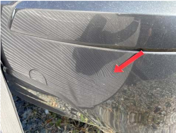
Stoßstange hinten (Verformung, Lackschaden)
