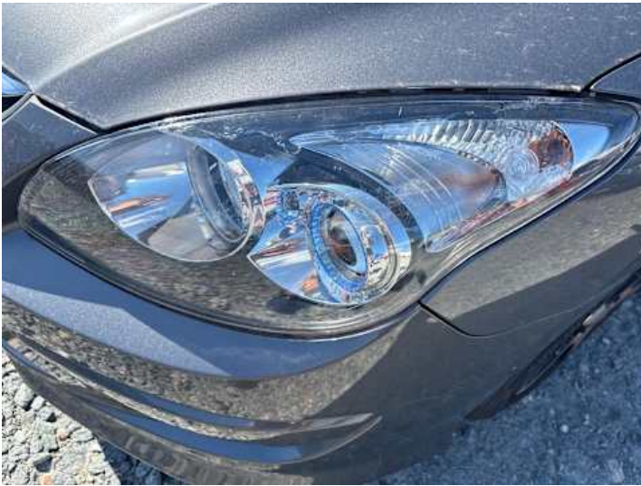
Scheinwerfer (links) (Anderer Schaden): Klarlack löst sich,
