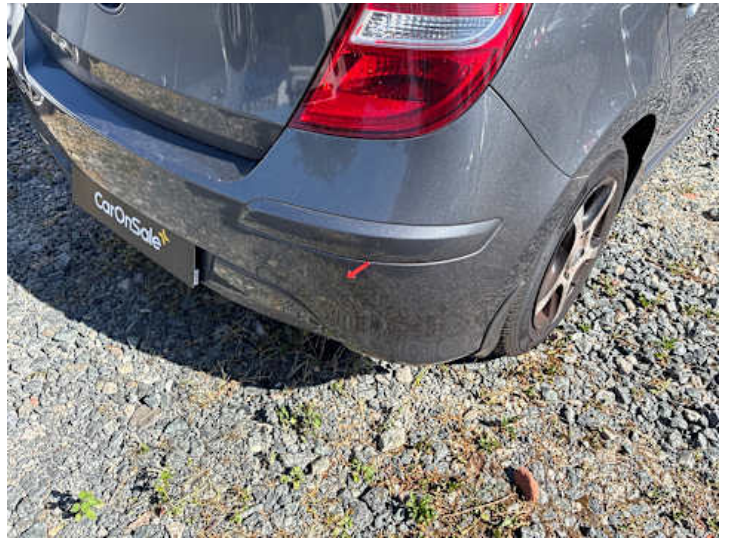
Stoßstange hinten (Verformung, Lackschaden)
