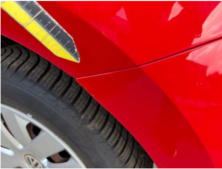
Stoßstange hinten (Verformung)
