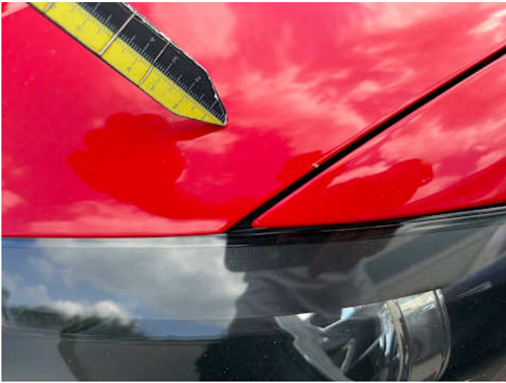
Motorhaube (Lackschaden, Kratzer, Steinschlag)
