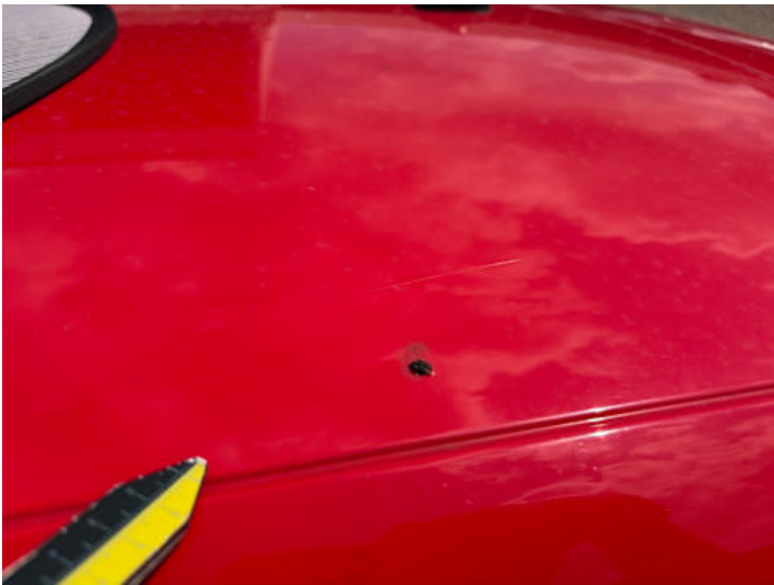
Dach (Kratzer, Lackschaden)
