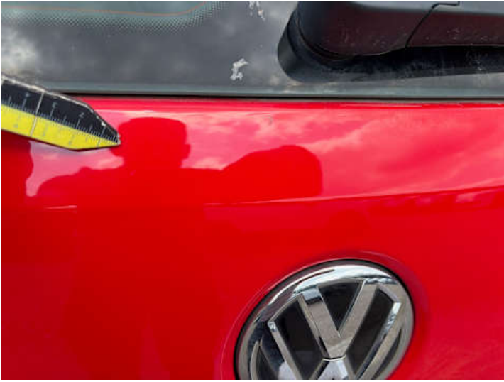
Heckklappe (Lackschaden, Kratzer)
