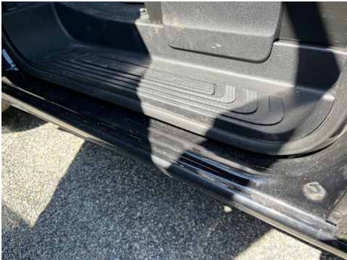
Schweller links (Kratzer, Delle)
