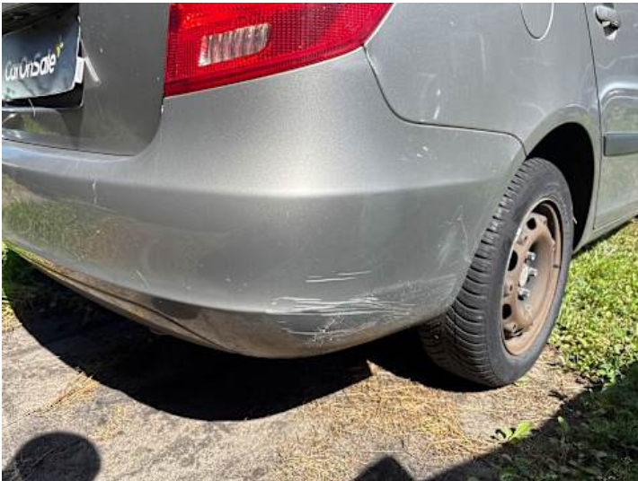
Stoßstange hinten (Kratzer, Riss/Bruch)
