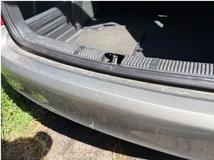
Stoßstange hinten (Kratzer, Riss/Bruch)
