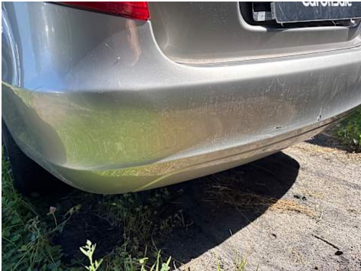
Stoßstange hinten (Kratzer, Riss/Bruch)
