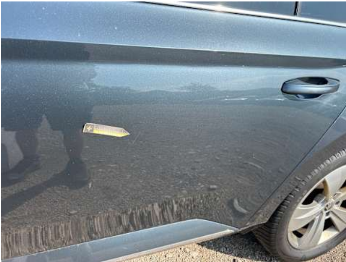
Türe hinten links (Kratzer)
