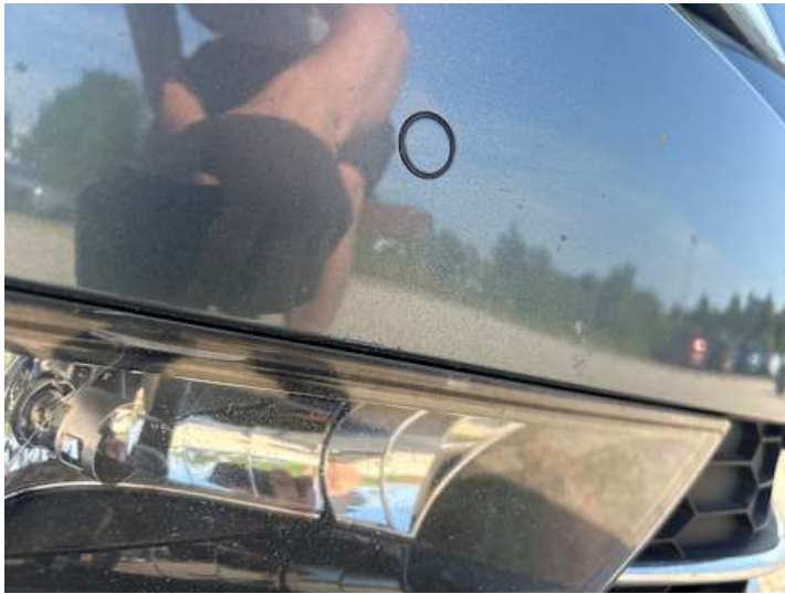
Stoßstange vorne (Kratzer, Lackschaden)
