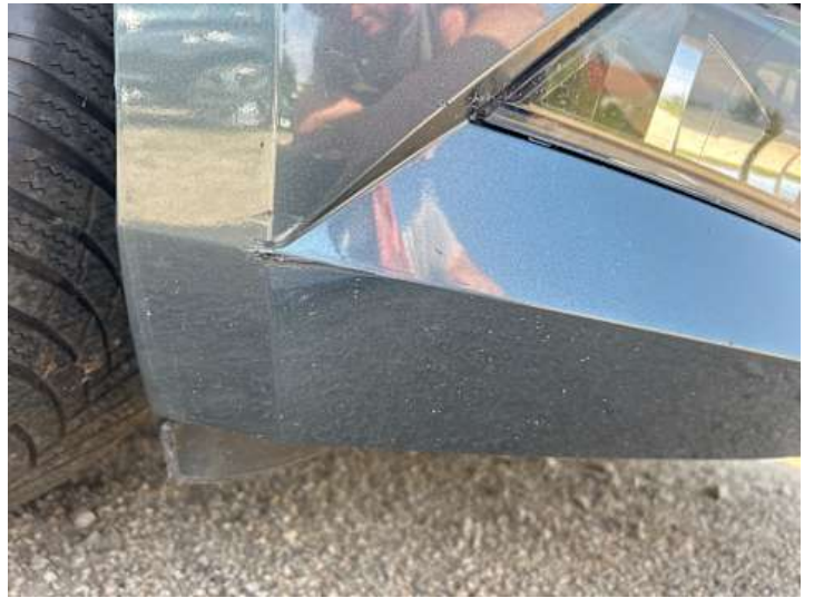
Stoßstange vorne (Kratzer, Lackschaden)
