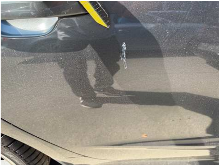
Türe hinten rechts (Lackschaden, Kratzer)
