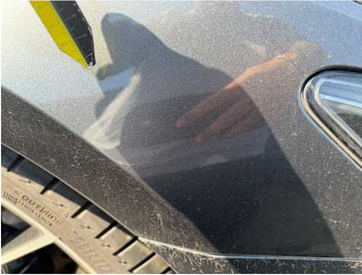
Kotflügel vorne rechts (Lackschaden, Kratzer)
