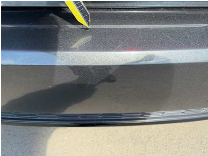
Stoßstange hinten (Lackschaden, Kratzer)
