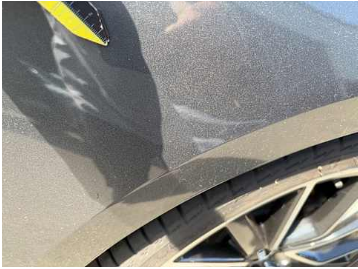
Seitenteil hinten rechts (Lackschaden, Kratzer)
