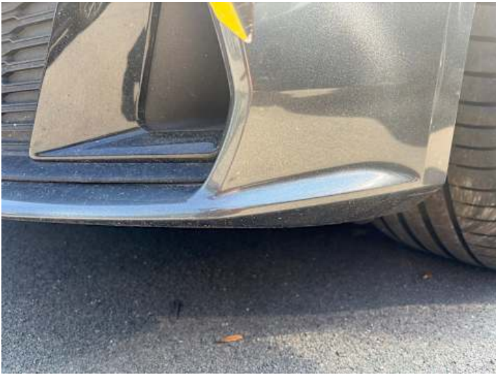
Stoßstange vorne (Lackschaden, Kratzer)
