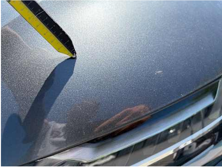
Motorhaube (Lackschaden, Steinschlag, Kratzer)
