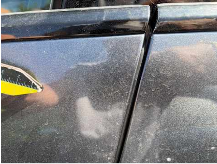
Fahrtür (Lackschaden, Kratzer)
