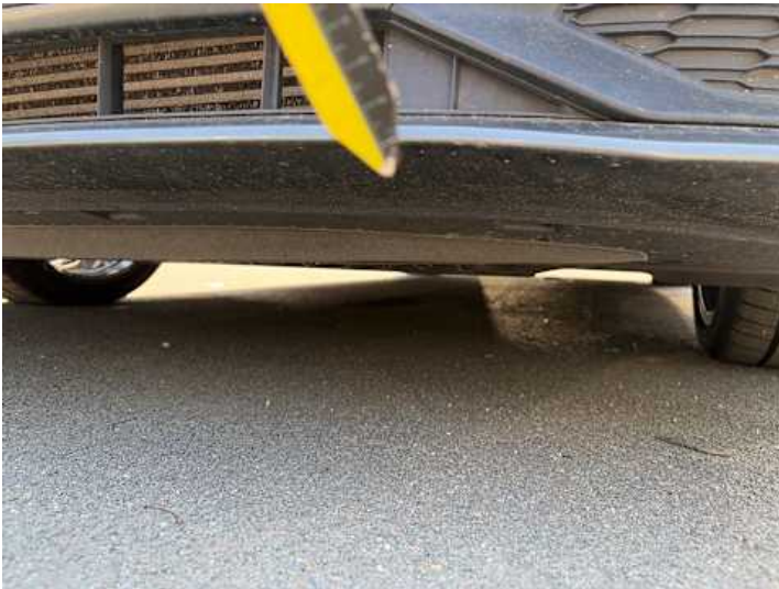
Stoßstange vorne (Lackschaden, Kratzer)
