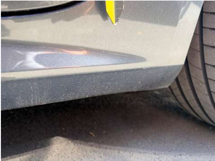
Schweller links (Lackschaden, Kratzer)
