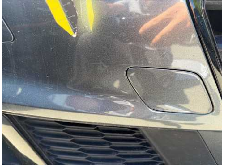
Stoßstange vorne (Lackschaden, Kratzer)
