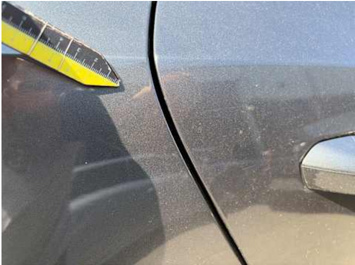
Türe hinten rechts (Lackschaden, Kratzer)
