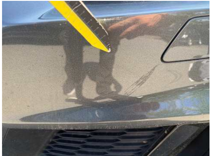
Stoßstange vorne (Lackschaden, Kratzer)
