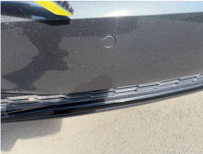
Stoßstange hinten (Lackschaden, Kratzer)
