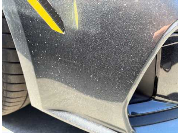
Stoßstange vorne (Lackschaden, Kratzer)
