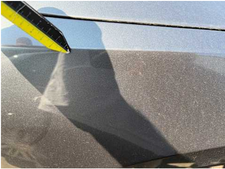
Kotflügel vorne rechts (Lackschaden, Kratzer)
