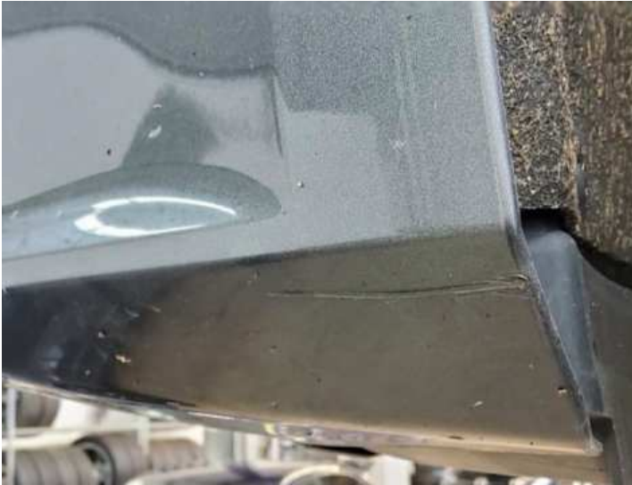
Stoßstange vorne (Lackschaden, Kratzer)
