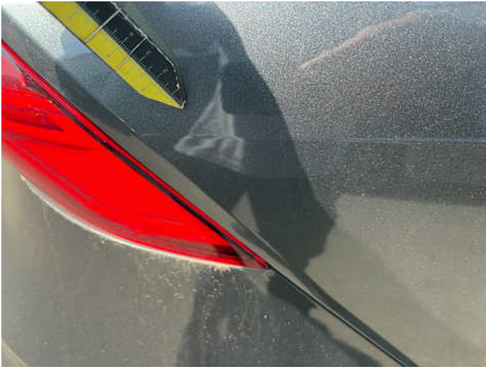
Seitenteil hinten rechts (Lackschaden, Kratzer)
