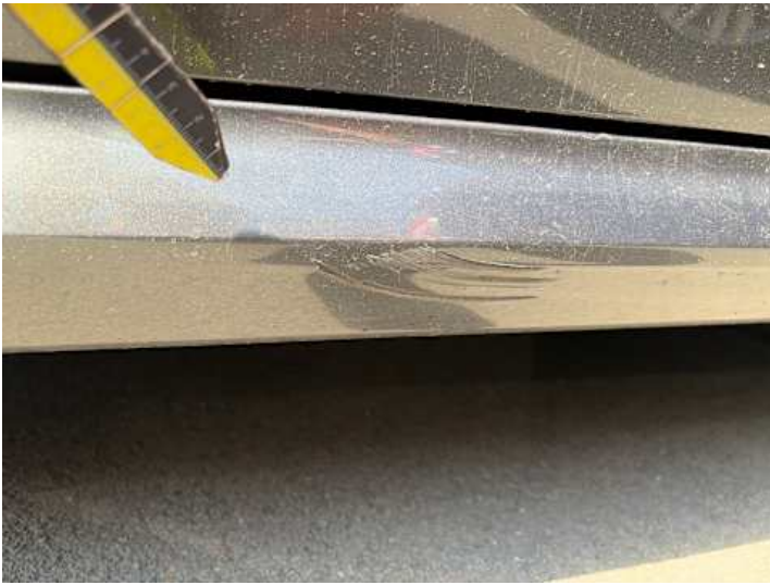
Schweller rechts (Lackschaden, Kratzer)
