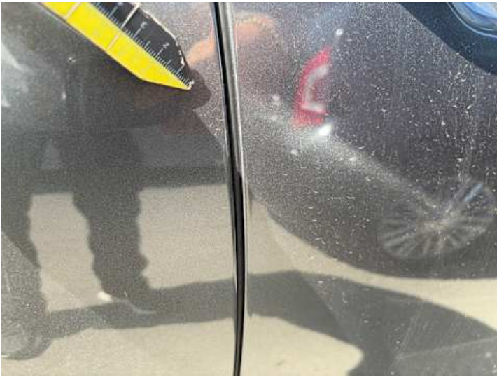
Beifahrertür (Lackschaden, Kratzer)
