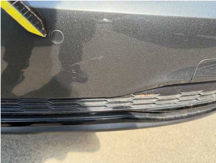
Stoßstange hinten (Lackschaden, Kratzer)
