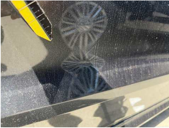
Beifahrtür (Lackschaden, Kratzer)
