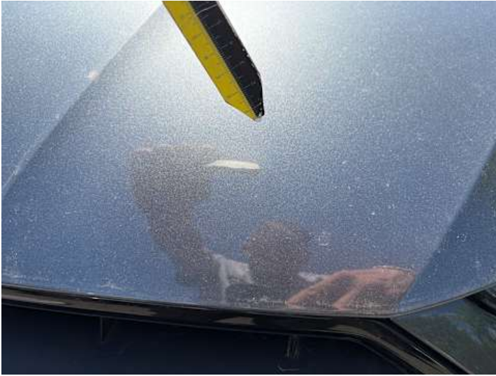
Motorhaube (Lackschaden, Steinschlag, Kratzer)
