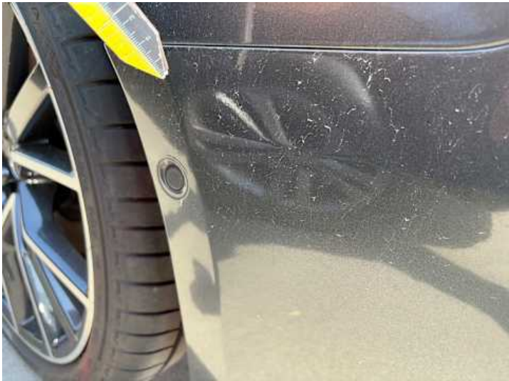
Stoßstange hinten (Lackschaden, Kratzer)
