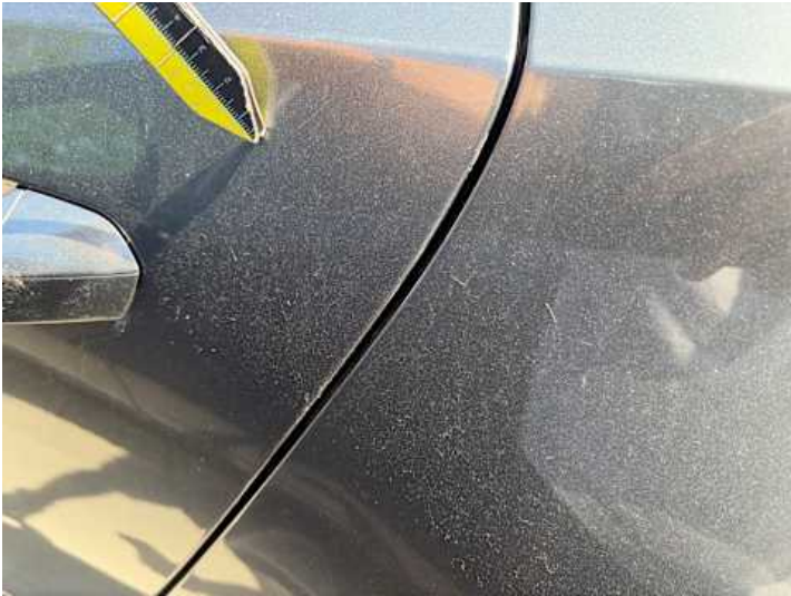
Türe hinten links (Lackschaden, Kratzer)
