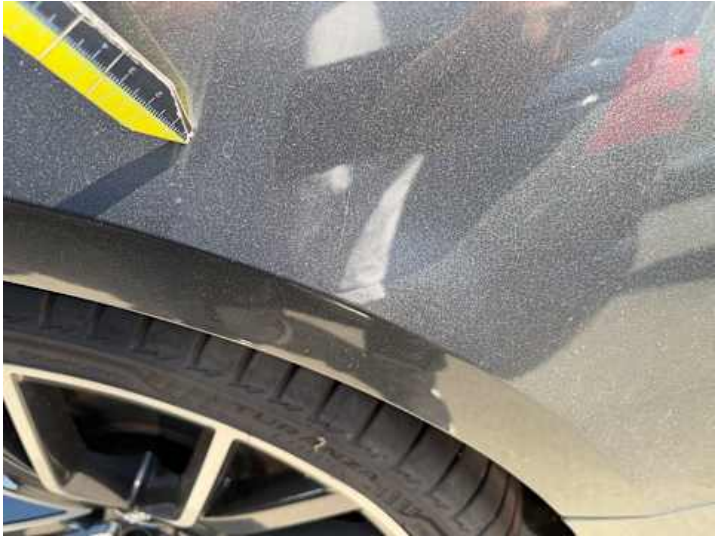
Seitenteil hinten links (Lackschaden, Kratzer)
