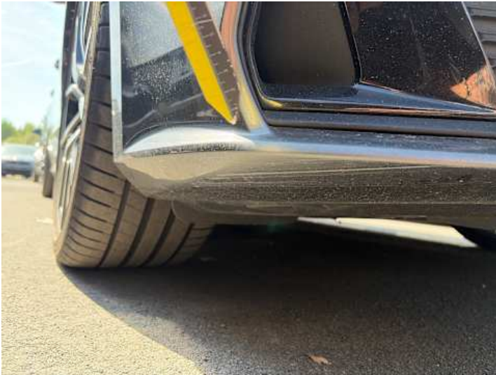
Stoßstange vorne (Lackschaden, Kratzer)
