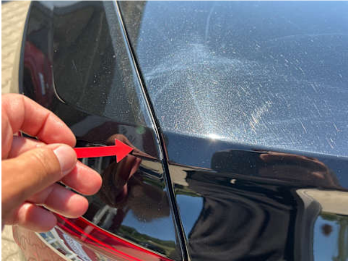
Seitenteil hinten links (Lackschaden)
