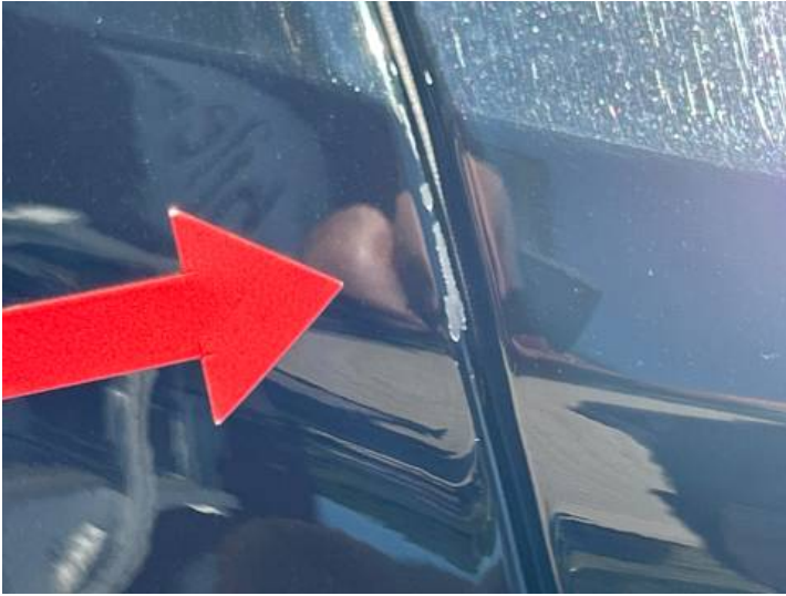
Seitenteil hinten links (Lackschaden)
