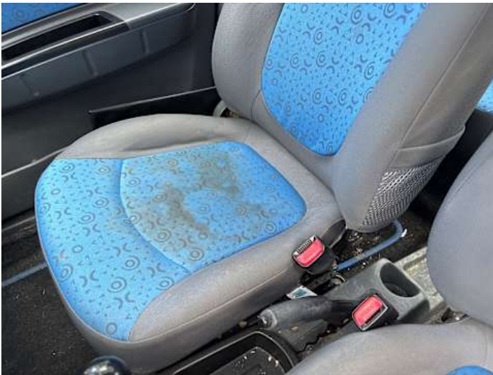
Innenraum (Verschmutzung, Verschleiß)
