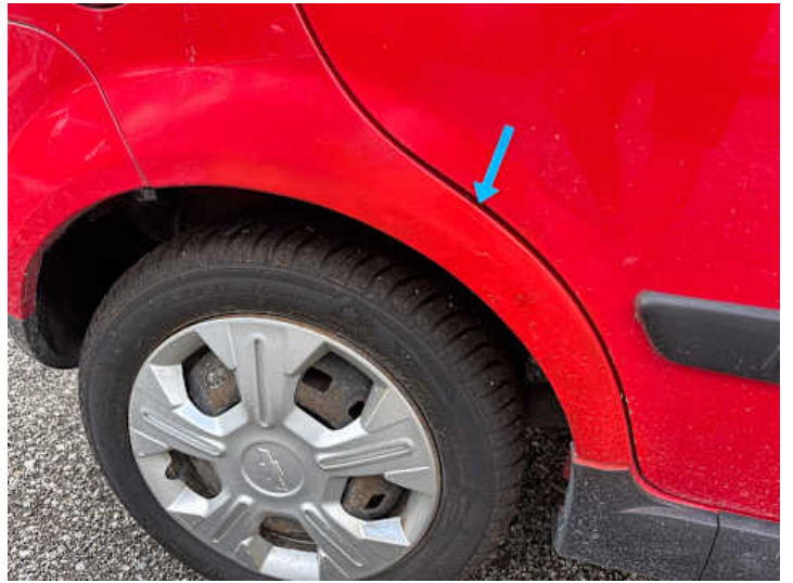
Seitenteil hinten rechts (Unsachgemäß instand gesetzt, Rost, Kratzer, Lackschaden)
