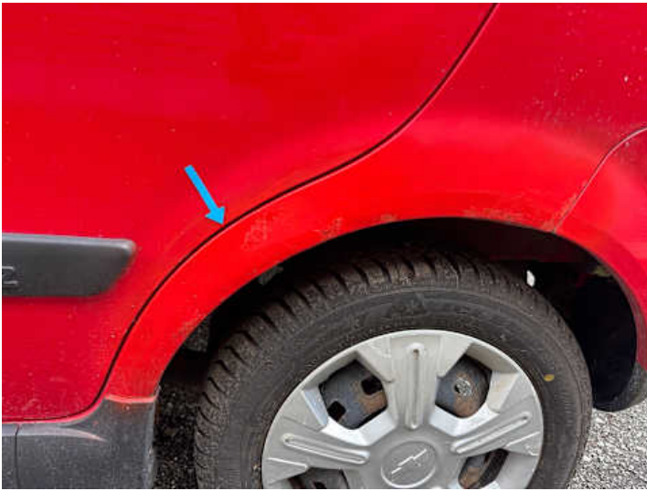
Seitenteil hinten links (Rost, Unsachgemäß instand gesetzt, Kratzer, Lackschaden)
