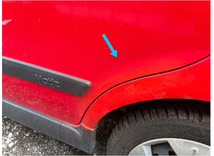
Türe hinten links (Unsachgemäß instand gesetzt, Lackschaden)
