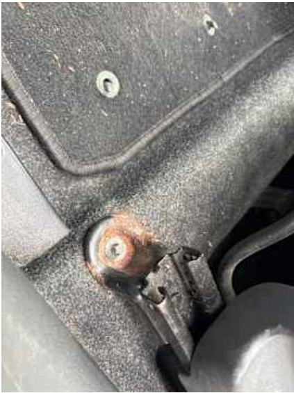
Innenraum (Anderer Schaden): Korrosion
