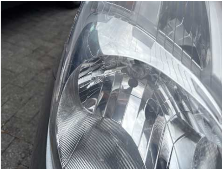
Scheinwerfer (rechts) (Anderer Schaden): Beschichtung löst sich
