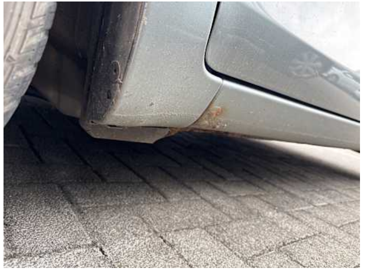
Schweller links (Rost)
