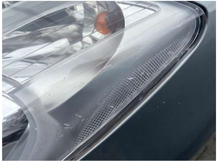
Scheinwerfer (links) (Anderer Schaden): Beschichtung löst sich
