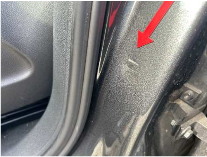
Schweller links (Lackschaden)
