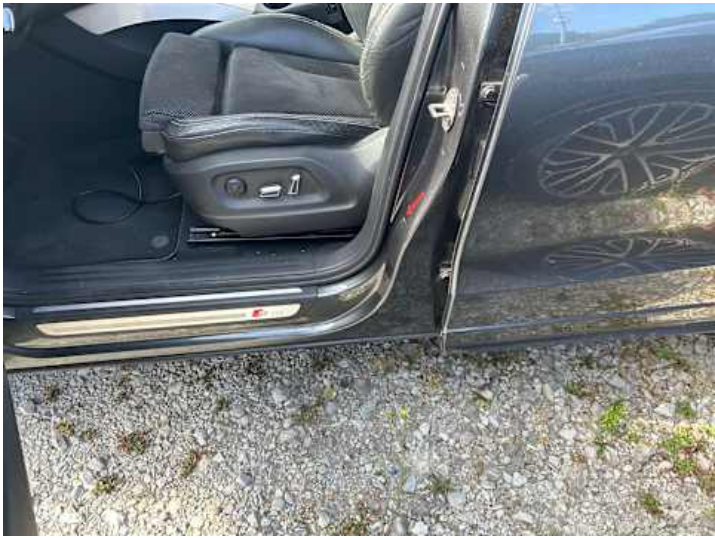
Schweller links (Lackschaden)
