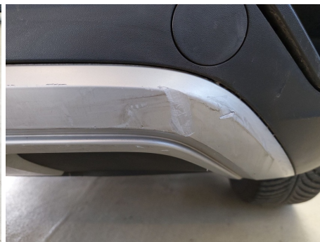
Stoßfängerleiste / Hinten / Kratzer
