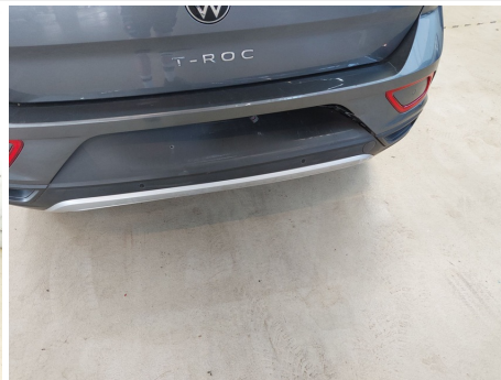
Stoßfänger unterhalb / Hinten / Riss
