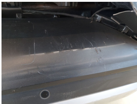
Stoßfänger unterhalb / Hinten / Riss
