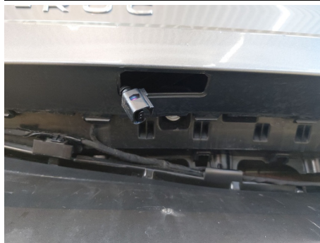
Kennzeichenleuchte / Rechts / Fehlt
