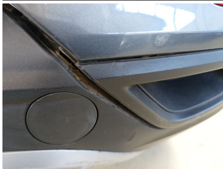
Zierrahmen Nebelscheinwerfer / Hinten Rechts / Kratzer
