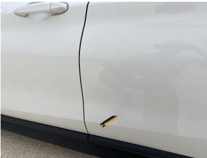
Türe hinten links (Steinschlag)
