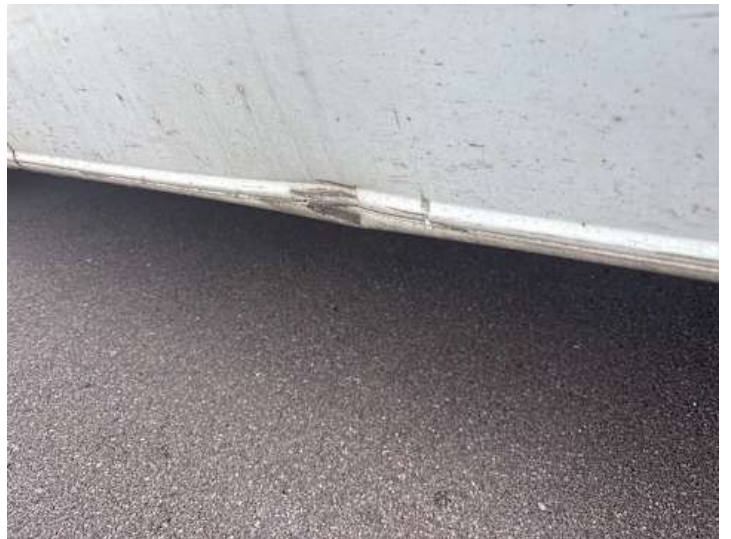
Schweller links (Kratzer, Verformung)
