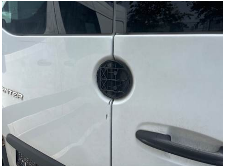
Heckklappe (Anderer Schaden): Emblem fehlt
