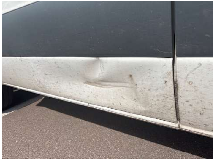
Türe hinten rechts (Verformung, Kratzer)
