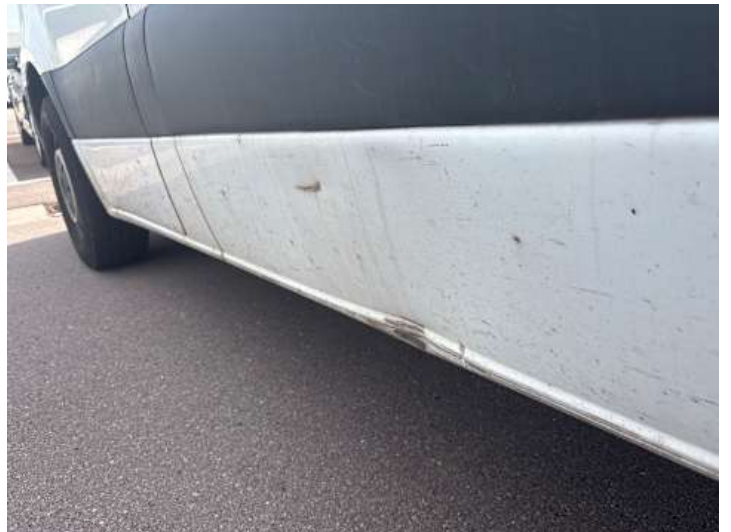
Seitenteil hinten links (Kratzer, Verformung)
