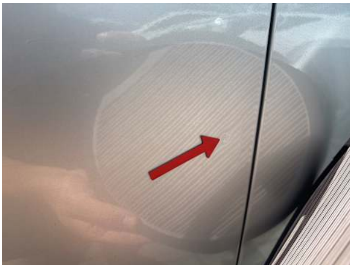
Fahrtür (Delle, Verformung)
