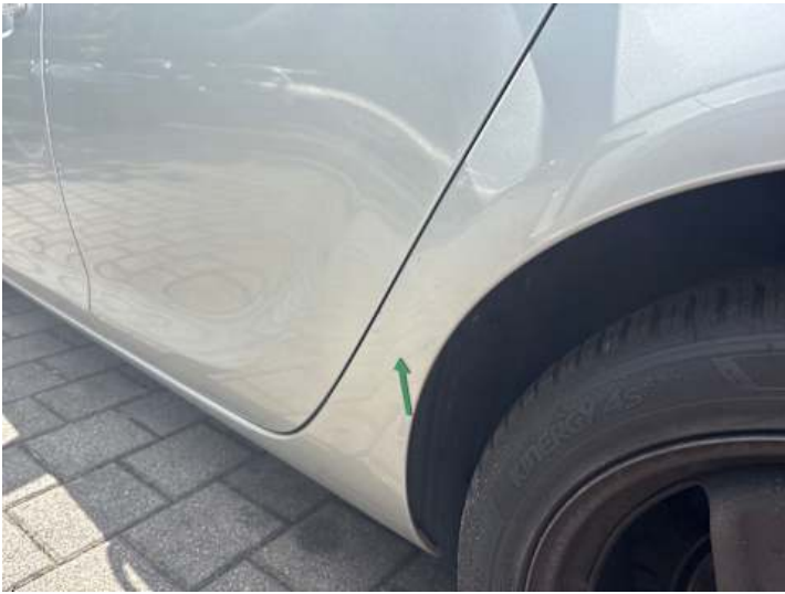
Seitenteil hinten links (Unsachgemäß instand gesetzt, Lackschaden)
