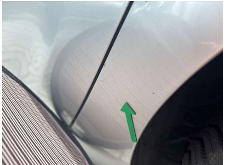
Seitenteil hinten links (Unsachgemäß instand gesetzt, Lackschaden)
