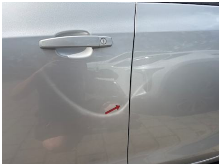
Fahrtür (Delle, Verformung)
