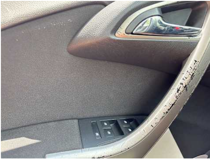
Innenraum (Kratzer, Verschleiß)
